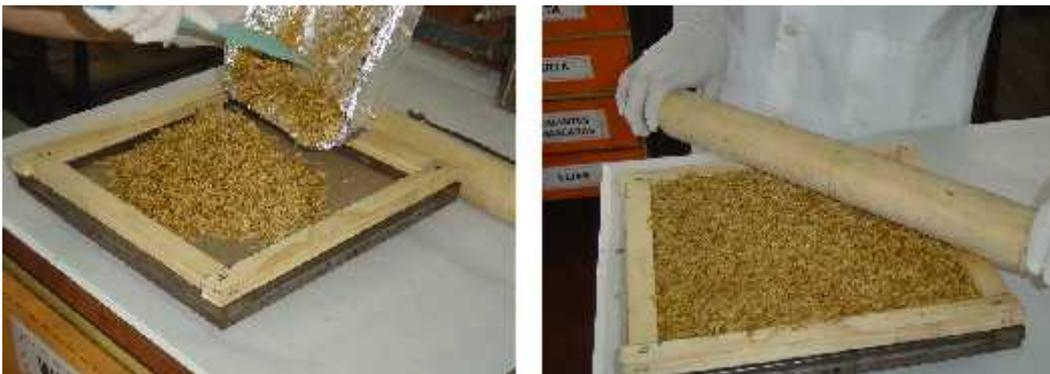
**Figura 2.2.** Premoldeado del aglomerado de CA-BCPS.
