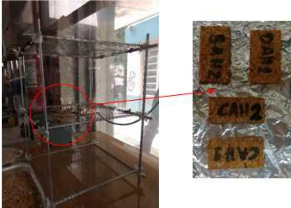
**Figura 2.9.** Ensayo de difusividad y absorción de humedad para probetas de CA-BSPC con y sin impregnación de aceite de tung.
