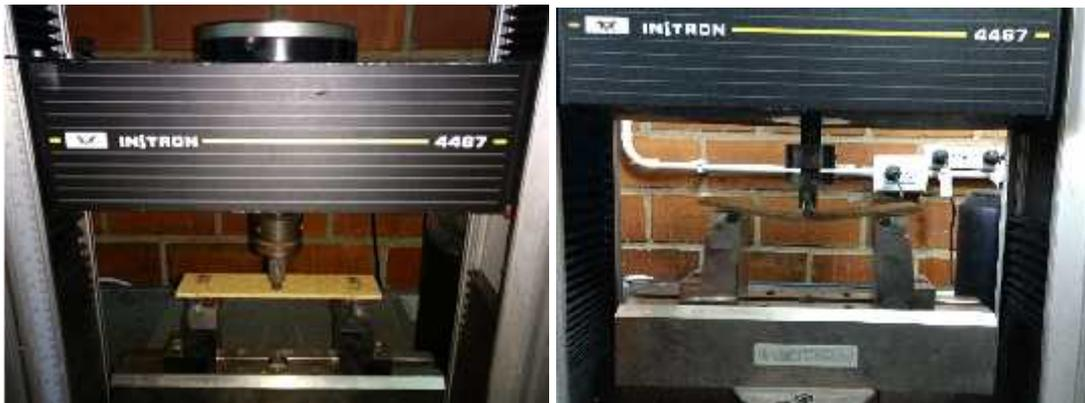
**Figura 2.11.** Ensayo de flexión en tres puntos de probetas de CA-BSPC.
