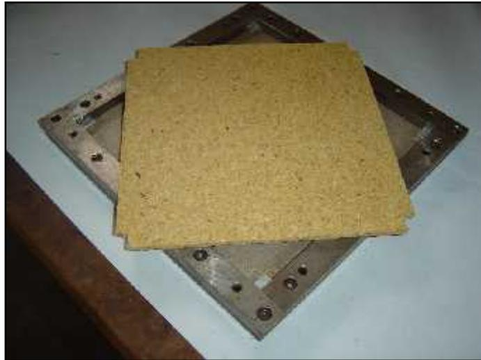
**Figura 2.4.** Desmolde de la placa de CA-BSPC.
