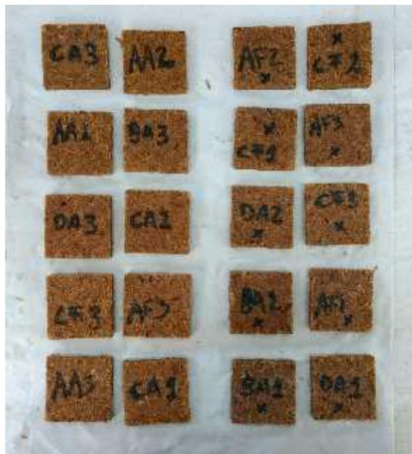
**Figura 3.1.** Muestras de aglomerados de CA-BSPC-SI (izquierda) y CA-BSPC-I (derecha) luego de ensayos de WA.
