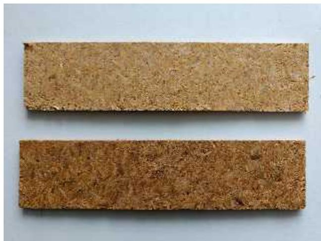
**Figura 2.7.** *Probeta de CA-BSPC sin impregnación (arriba). Probeta de BSPC impregnadas (abajo).*
