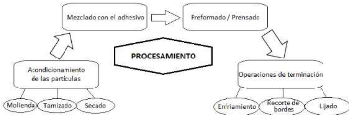
**Figura 1.2.** Proceso de fabricación de tableros de partículas.
