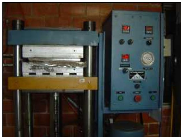
**Figura 2.3.** Prensado de la placa de CA-BSPC.
