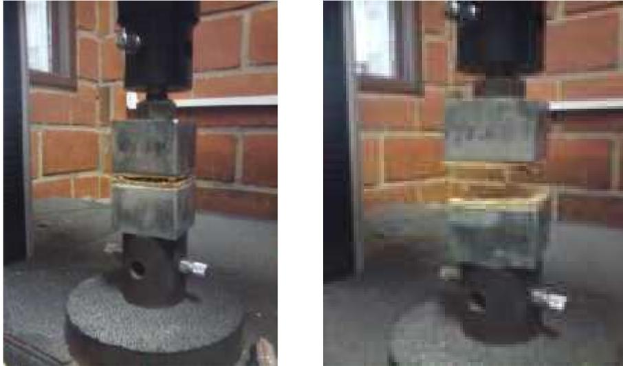
**Figura 3.10.** Rotura en ensayo de IB para probetas de CA-BSPC-SI y CA-BSPC-I.
