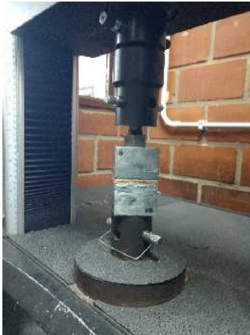
**Figura 2.12.** Ensayo de adhesión interna para probetas de CA-BSPC.
