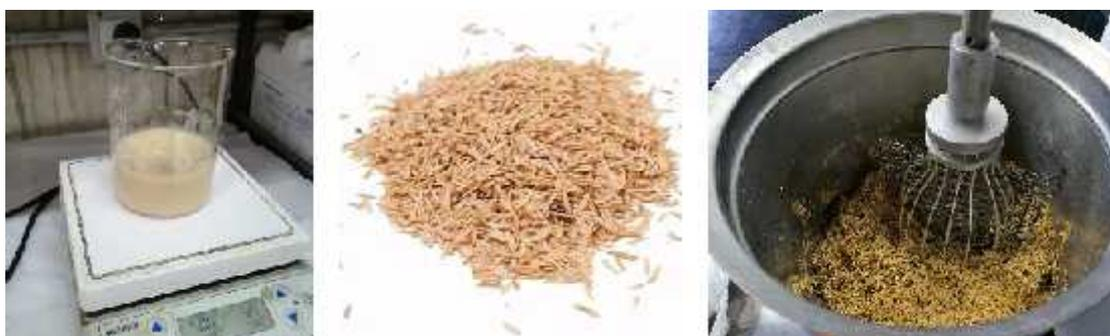
**Figura 2.1.** Preparación del adhesivo BSPC y mezclado con CA.
