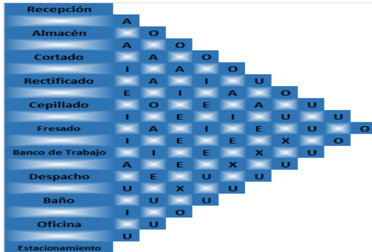
Figura 32: Diagrama de relación de actividades para el establecimiento. Referencias: A (cercanía necesaria), E (cercanía muy importante), I (cercanía importante), O (cercanía ordinariamente importante), U (sin importancia), X (no deseable). (Elaboración propia).
