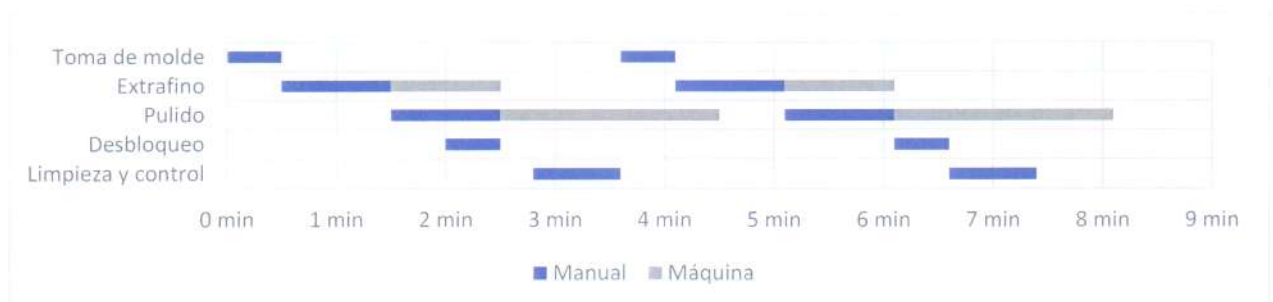
Figura 16: Tabla de carga de trabajo en Celda B. Fuente: Elaboración propia.
