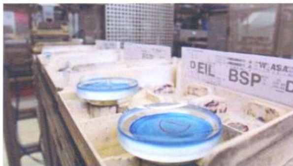
Figura 7: Comparación "block en bruto" (izquierda) y "lente de stock" (derecha). Fuente: Zeiss.
