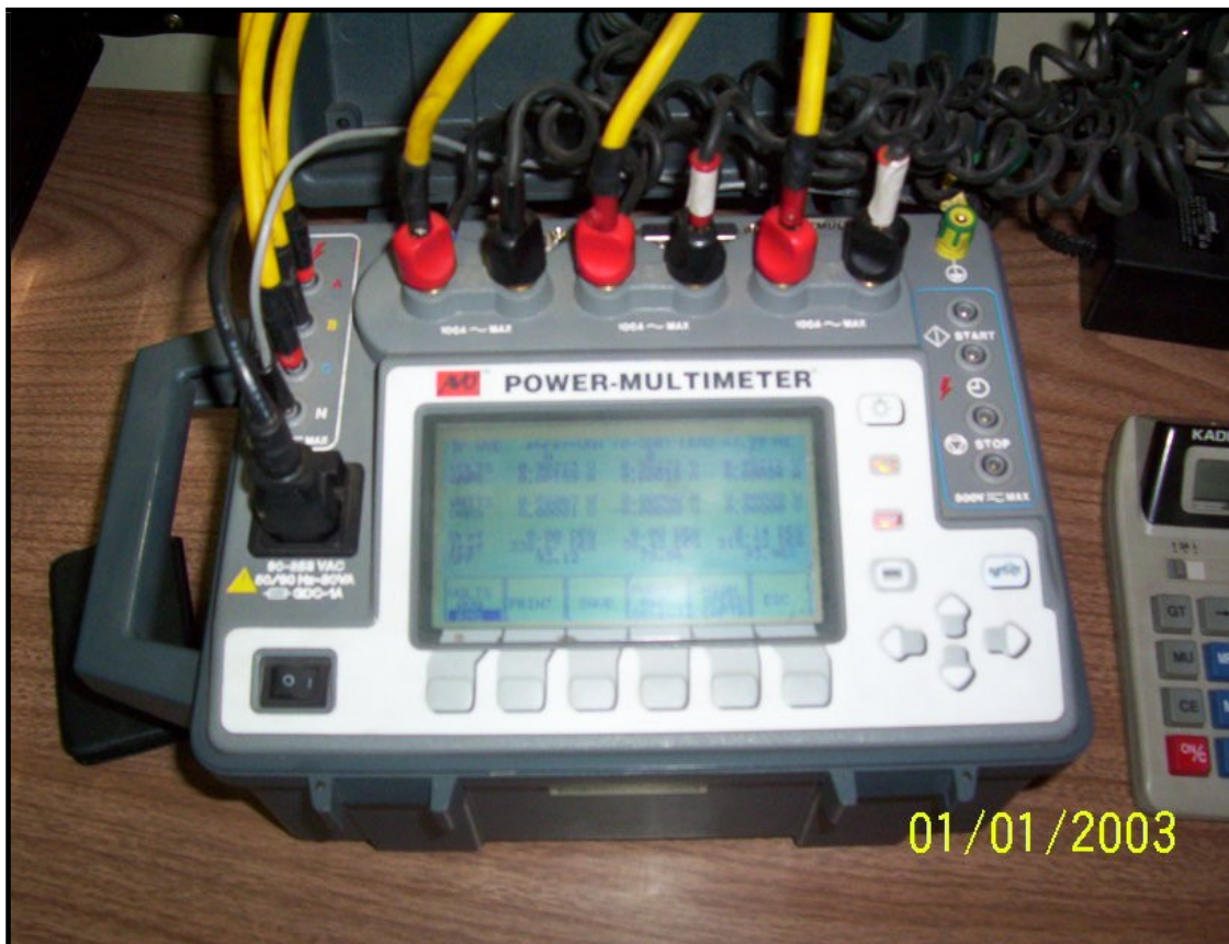
Foto 9: A.V.O (Instrumento para la medición de Pérdidas)
