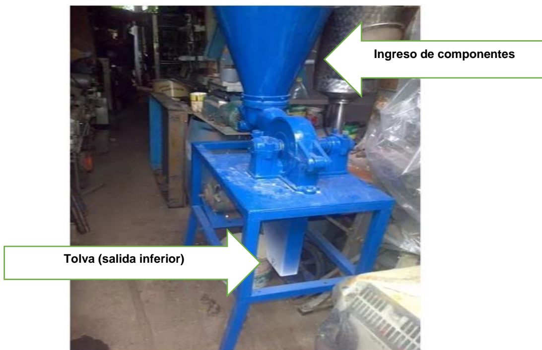
Figura I.14: Modelo de Trituradora con tolva inferior.
