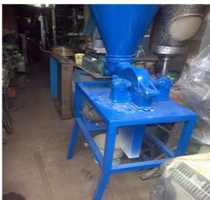
Figura 22: Modelo de Trituradora con tolva inferior.
