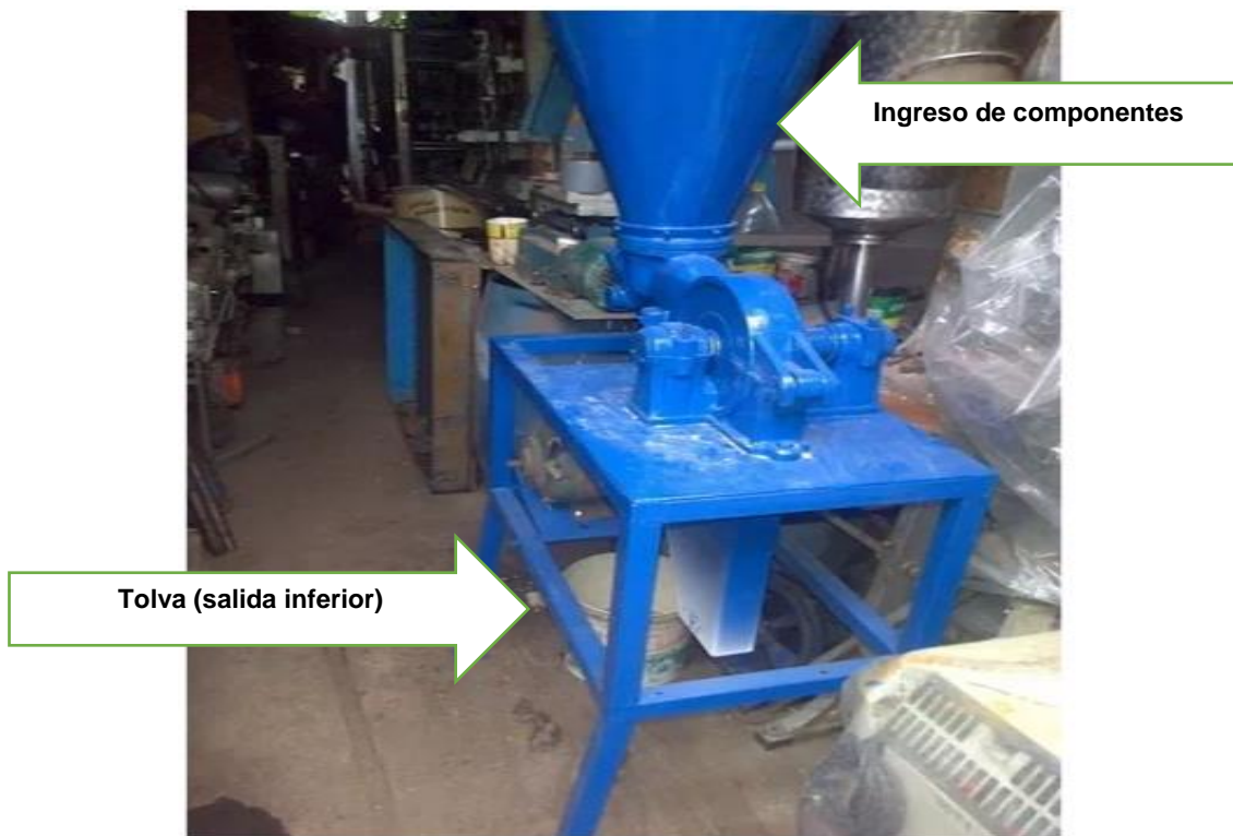
Figura I.13: Modelo de Trituradora con tolva inferior.
