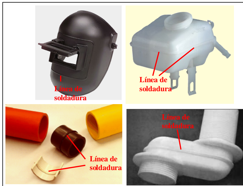
Figura 2.1: Piezas soldadas por termofusión.
