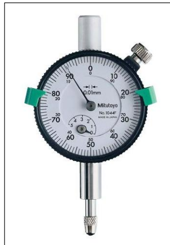
Figura 2.14: Alesómetro utilizado para medir la deformación de los resortes.
