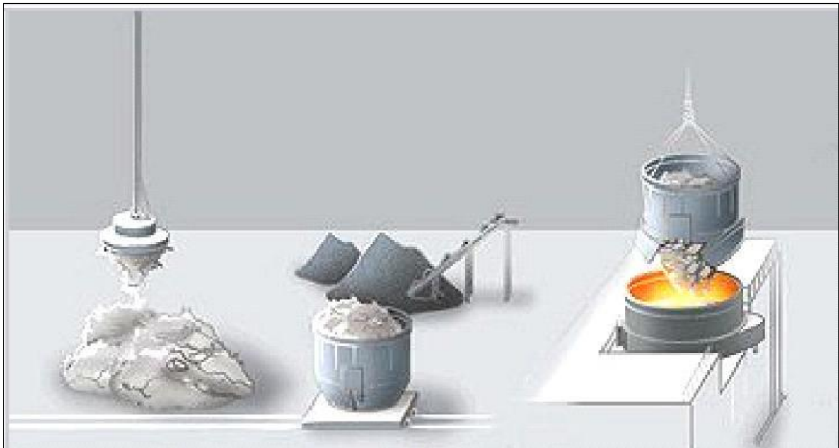
La chatarra metálica se carga al horno por medio de una cesta
