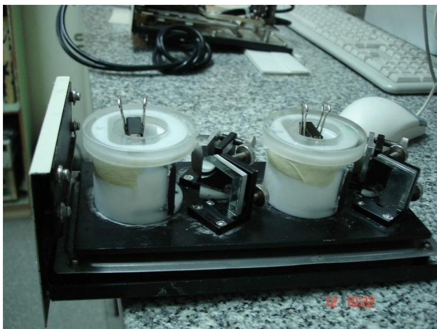
Figura 11. Dispositivo experimental para ensayo espectrofotométrico de los biofilms compuesta por dos celdas cilíndricas.
