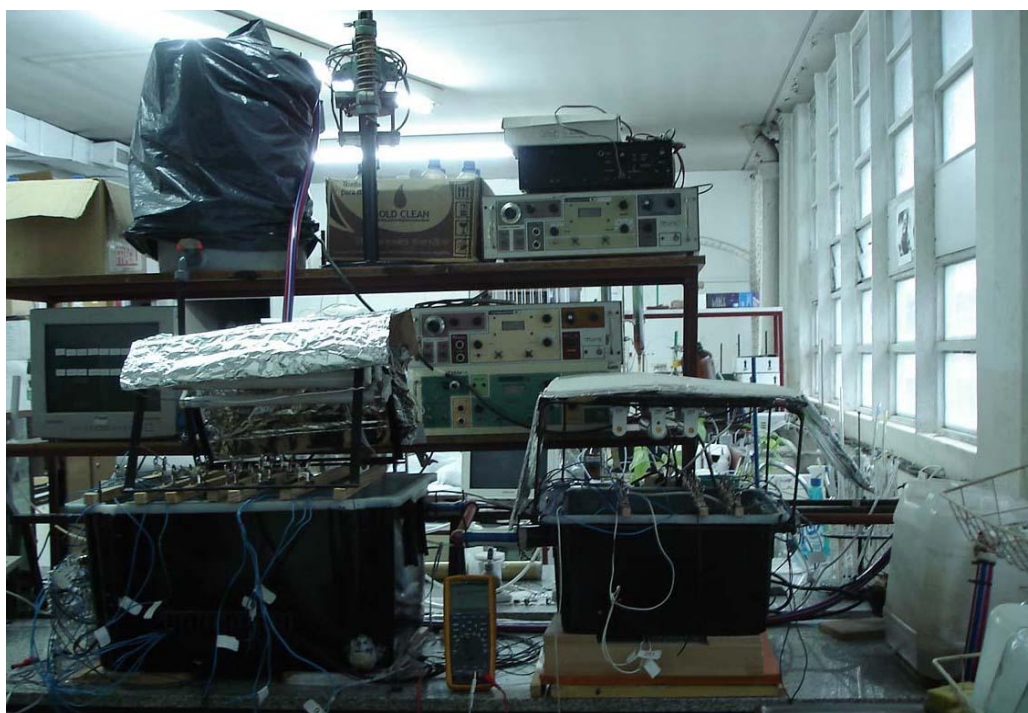
Figura 9. Sistema Experimental de laboratorio formado por las dos piletas de polipropileno de color negro, un tanque de almacenamiento, un reservorio y una bomba de agua.
