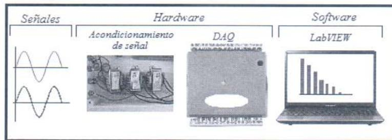
Figura 3.2-Esquema general de un Instrumento Virtual
