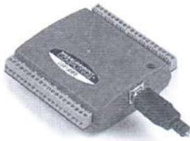
Resolución de 12 Bit, 50 KS/s, 8 entradas analógicas, Alimentación y transmisión de datos a través de cable USB.
