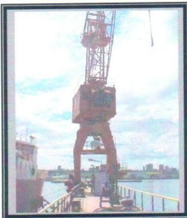
Las mismas están dispuestas en cada lateral y su movimiento se efectúa sobre rieles. Estas forman parte del servicio brindado por el dique y son utilizadas para el movimiento de contenedores, equipos, hélices, chapas, líneas de eje, etc. Esta máquina posee movimientos de traslación y giro. Cada una de ellas esta compuesta por dos motores de traslación de 9.5 Kw.; un motor de giro de cabina
