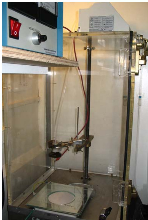
Figura 8.3: Equipo de electrospinning construido en nuestro laboratorio.
