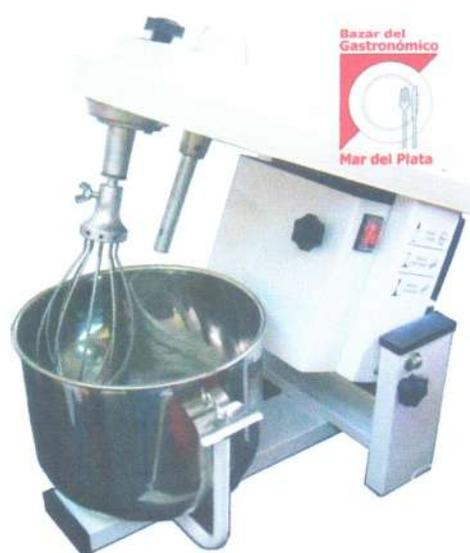
Figura 8.2: Batidora Planetaria Ceico 10L.
