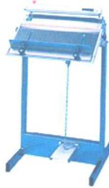
Figura 8.10: Termoselladora de temperatura constante.
