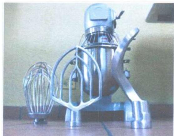
Figura 8.3: Batidora Planetaria 60L Argental. Accesorios.
