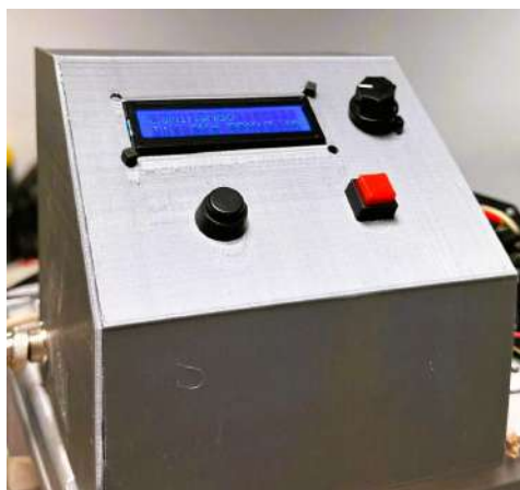
Figura 18. Caja de control del módulo tensionador y esquema de las conexiones eléctricas del sistema.
