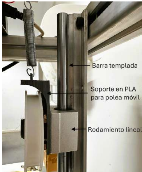
Figura 16. Conjunto para deslizamiento de la polea móvil.
