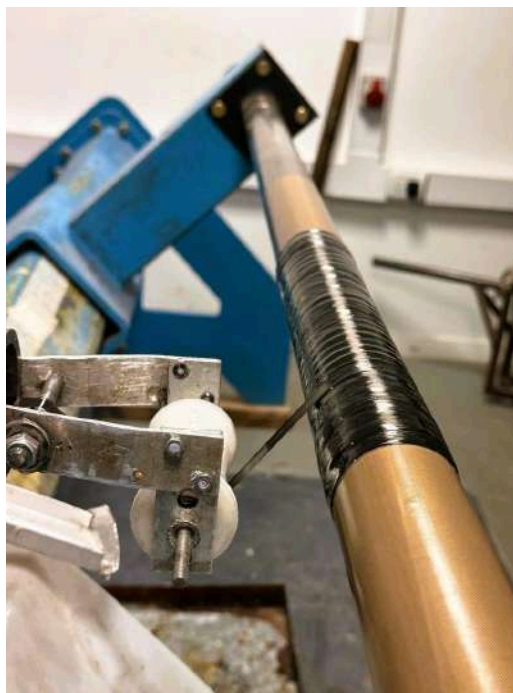
Figura 40. Deposición de la mecha de fibra impregnada sobre el mandril por el devanador durante la última capa de bobinado.
