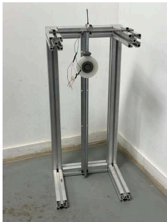
Figura 15. Detalle del montaje de la celda de carga, resorte y vista general de la estructura de perfiles de aluminio.
