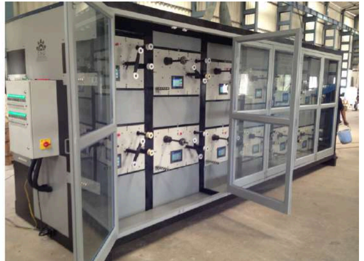
Figura 6. Dispositivo para el control de tensión industrial para el proceso de Filament Winding [13].
