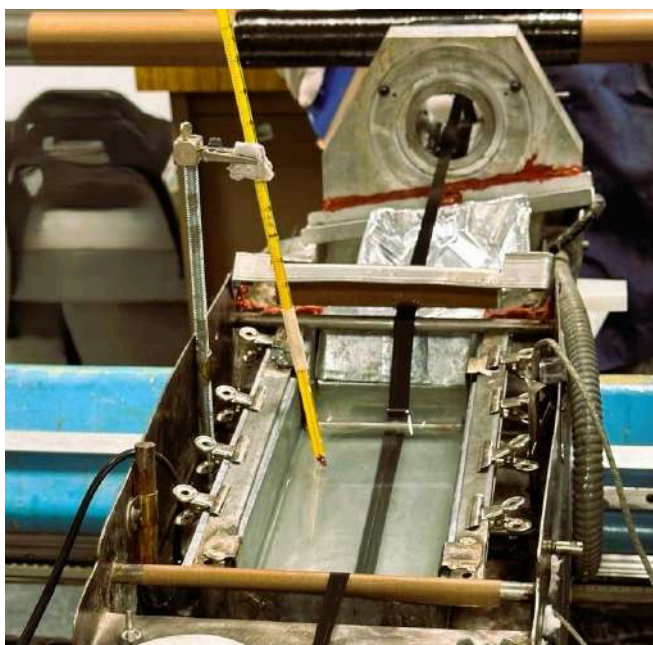
Figura 37. Batea con la resina formulada. Se observa el termómetro para el monitoreo de la temperatura del baño y la mecha de fibra durante su paso a través de la resina en dirección al rodillo devanador.
