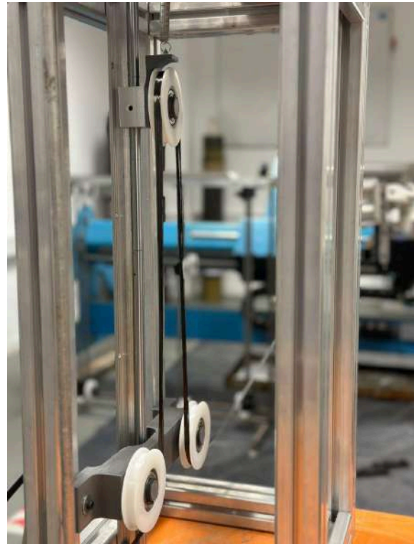
Figura 14. Módulo tensionador: vista del sistema de poleas y recorrido de la fibra.
