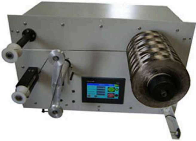
Figura 6. Dispositivo para el control de tensión industrial para el proceso de Filament Winding [13].
