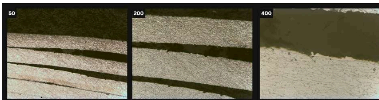
Figura 3.27 Micrografía sector B recubrimiento con ataque químico (aumentos x50 x200 x400 respectivamente).
