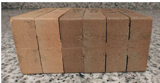
Figura 5.2 Ladrillos con incorporación de R-MZ al 5 %, 10 % y 20 % (dos piezas por composición, de izquierda a derecha), donde se aprecia el oscurecimiento progresivo característico de la presencia de óxidos de manganeso ( Mn_xO_y ).
