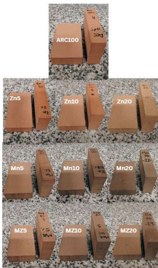
Figura 4.1 Ladrillos obtenidos para todas las formulaciones declaradas en la Tabla 4.1.
