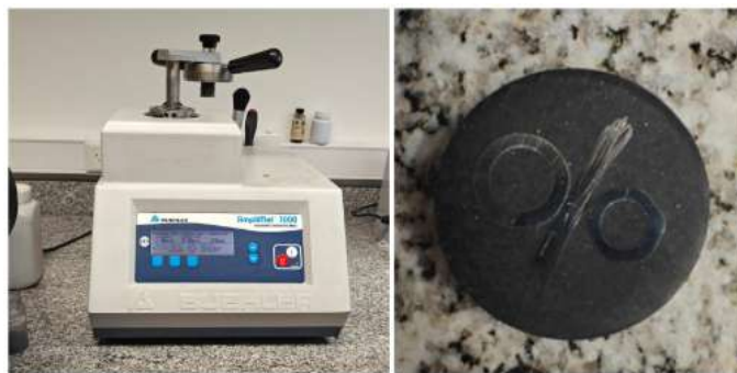
Figura 3.24 Prensa automática Buehler Simplimet 1000. Inclusión de las secciones del recubrimiento en resina fenólica.
