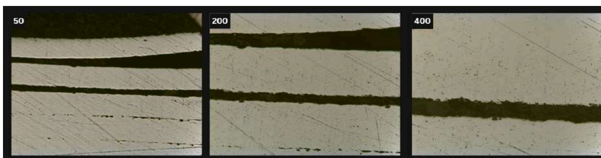
Figura 3.26 Micrografía sector B recubrimiento sin ataque químico (aumentos x50 x200 x400 respectivamente).
