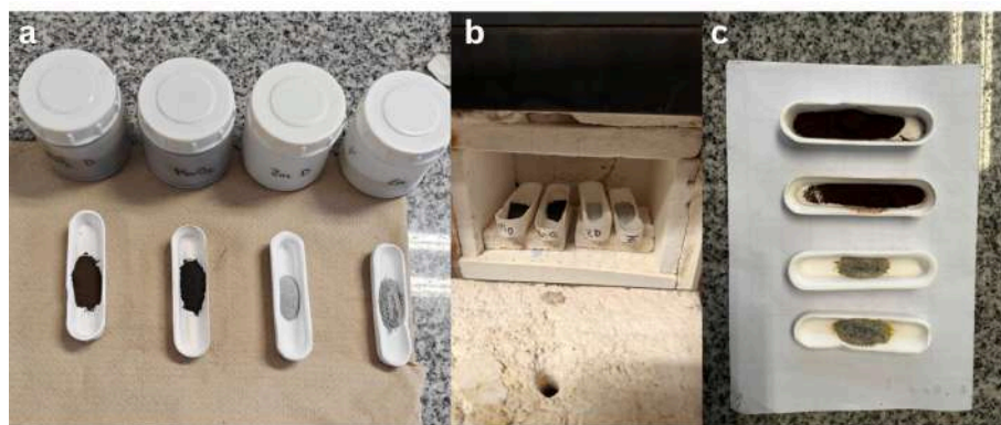
Figura 3.23 (a) Óxidos antes de la evaluación térmica; (b) óxidos en el horno; (c) óxidos luego de la evaluación térmica. (Orden de izquierda a derecha: R-Mn descargado, R-Mn cargado, R-Zn descargado, R-Zn cargado).
