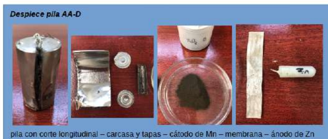
Figura 3.10 Despiece de pila ‘AA’, formato D.
