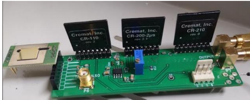
Figura 6.1.2. Acondicionamiento de señal (Front End).
