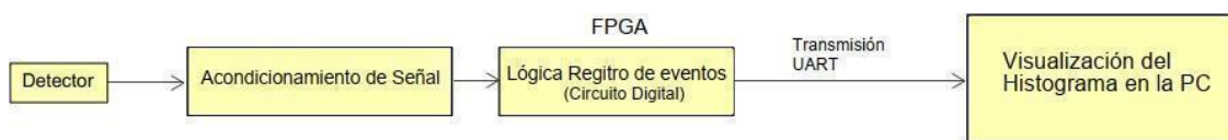
Figura D1. Diagrama general en bloques del dispositivo.
