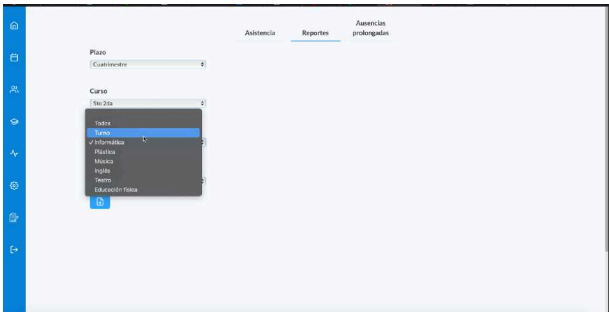
Figura 4. Pantalla de toma de asistencia en la que un usuario con roles de profesor y administrador visualiza todos los cursos del sistema, evidenciando la falta de filtrado según el rol docente.
