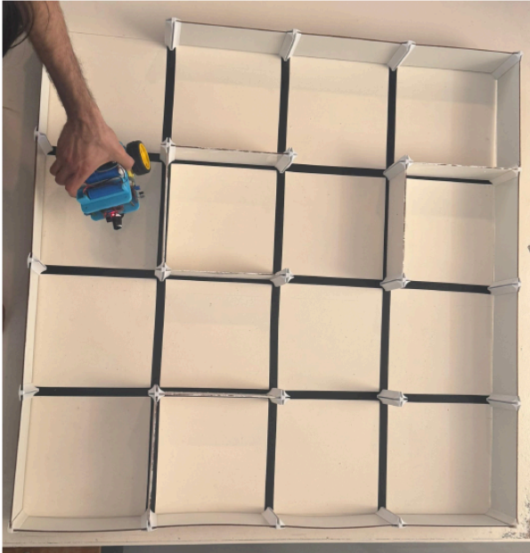
Figura 2 - Laberinto implementado con paredes rebatibles.
