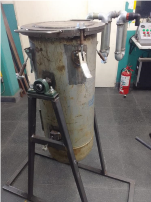
Figura 4 - Fotografía del Gasificador fabricado en los talleres de la Facultad de Ingeniería.
