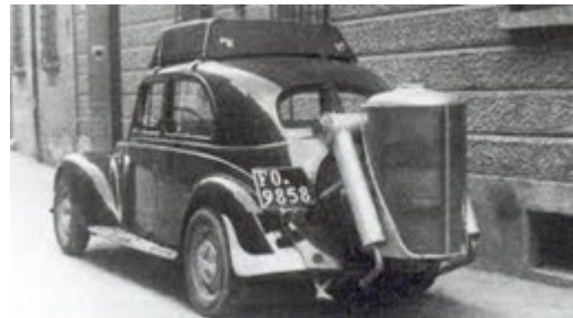
Figura 1 - Automóvil dotado de un gasificador en la parte posterior del mismo (1945).
