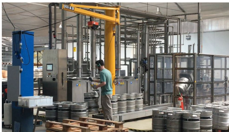
Figura A.3.7: Imagen paletizado de barriles.
