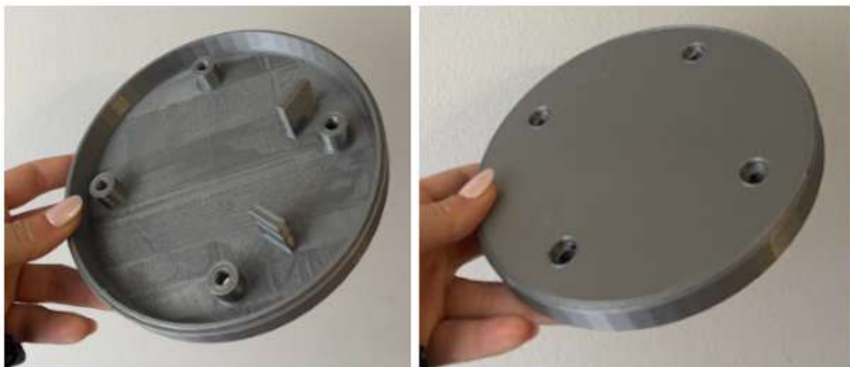
Figura 8.1.2.g: Tapa del cuerpo del dispositivo que aloja componentes electrónicos, frente y dorso.
