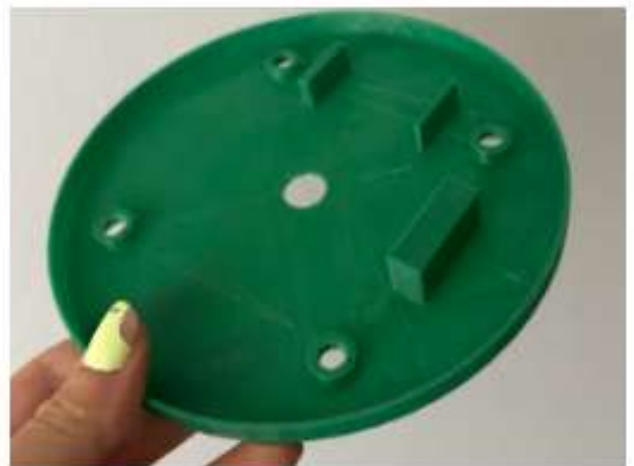
Figura 8.1.1.j: Tapa del cuerpo del dispositivo que aloja componentes electrónicos, frente y dorso.
