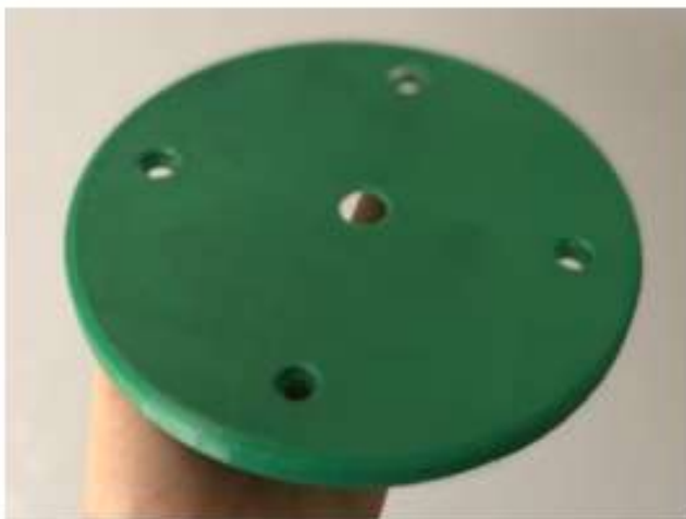
Figura 8.1.1.j: Tapa del cuerpo del dispositivo que aloja componentes electrónicos, frente y dorso.
