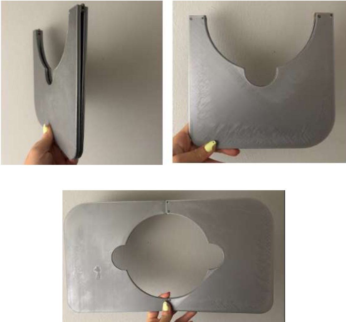
Figura 8.1.2.k: Soporte del dispositivo impreso, vistas abiertas y plegadas.
