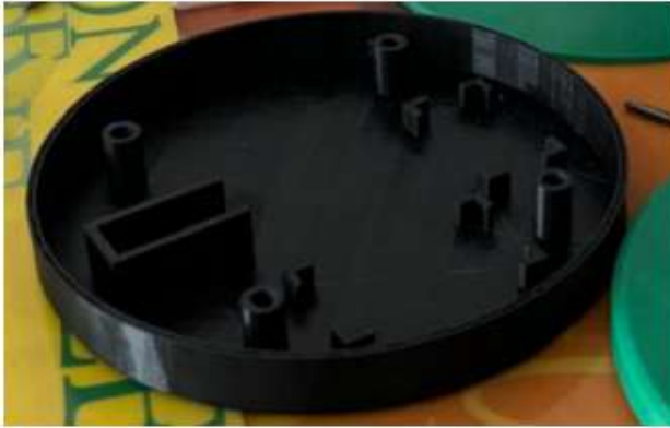
Figura 8.1.1.i: Base del cuerpo del dispositivo que aloja componentes electrónicos, frente y dorso.
