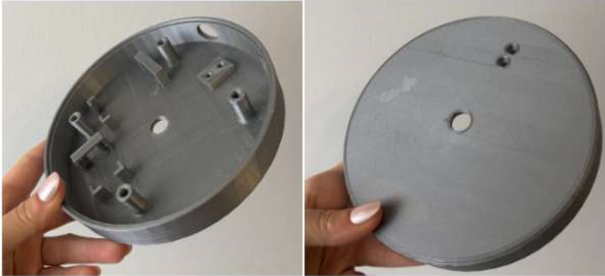
Figura 8.1.2.f: Base del cuerpo del dispositivo que aloja componentes electrónicos, frente y dorso.
