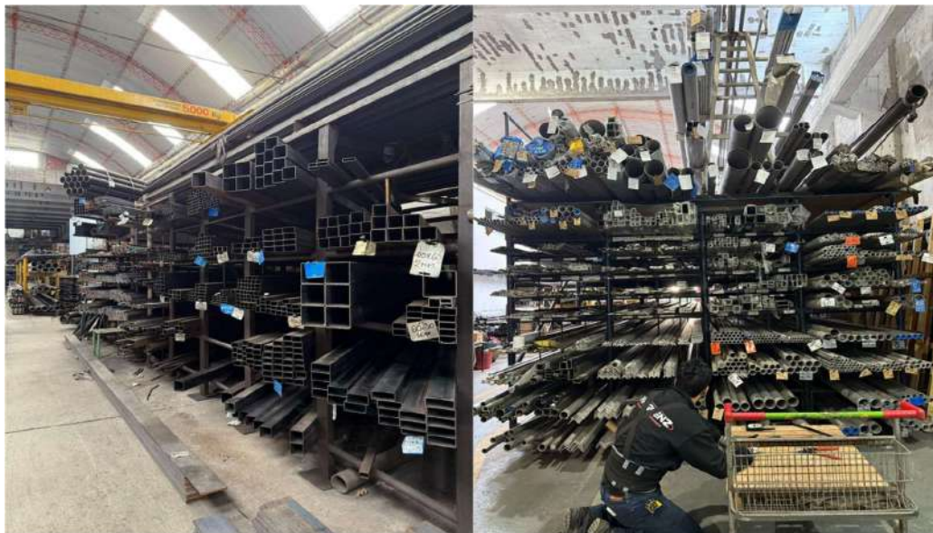
Figura 11: Estanterías utilizadas para el almacenamiento de materiales. Fuente: Fotografía propia (2025).
