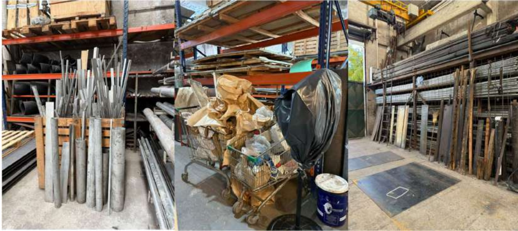
Figura 12: Acumulación de desperdicios, recortes y suciedad en el área de trabajo.
