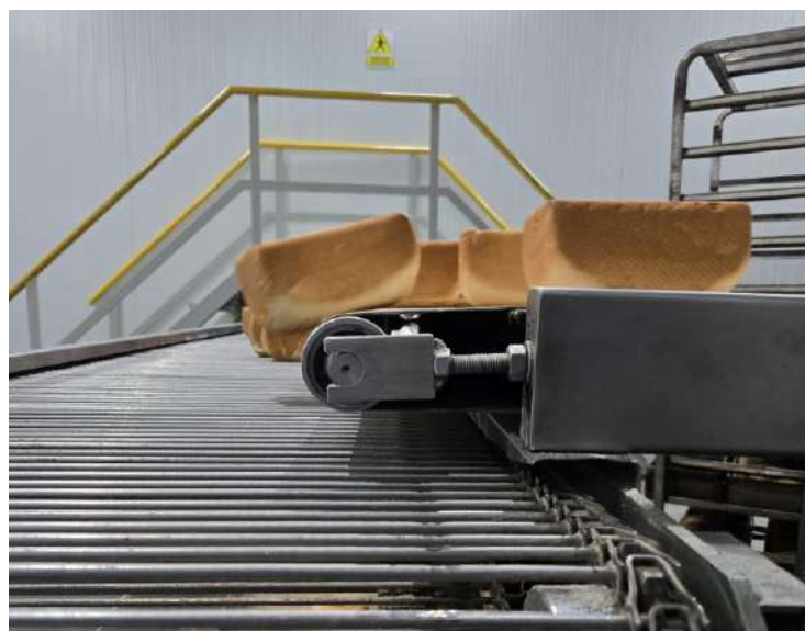
Figura 24: Desnivel entre cintas a la salida del horno
