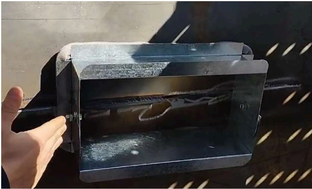
Figura 15: Módulo de contención para soldadores sin respiradores
