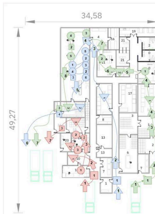
Figura 6: Diagrama de recorrido del nuevo centro de elaboración Fuente: Elaboración propia
