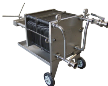
Figura 12. Filtro de placas
