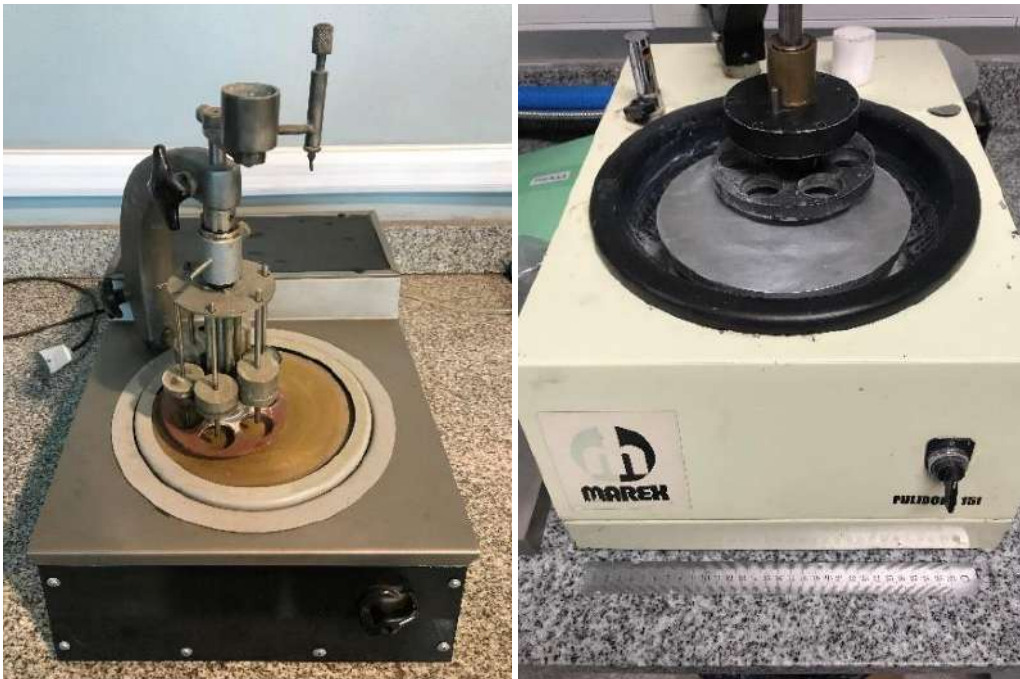
Fig. 15 – Pulidoras de INTEMA con portamuestras incorporado
