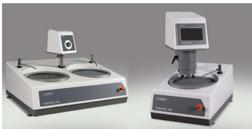
Fig. 8 – Forcipol 202 con unidad de control (izquierda) y Forcipol 102 con cabezal Forcimat (derecha) (Metkon, 2023).
