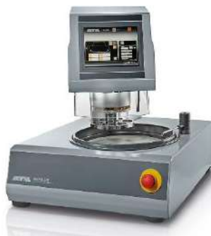
Fig. 12 – Pulidora automática Saphir (QATM, 2023)
