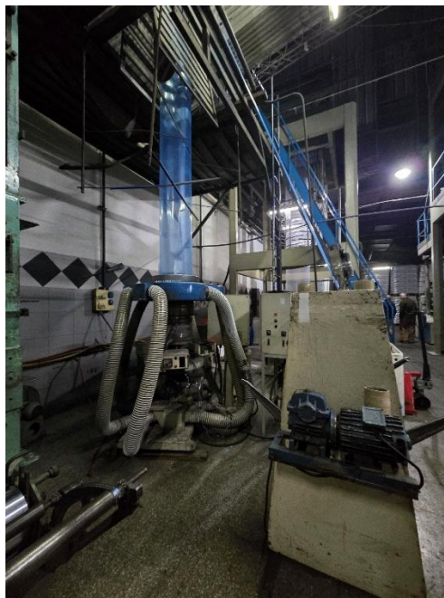
Figura 6-3: Extrusora de film. Plásticos del Mar.
