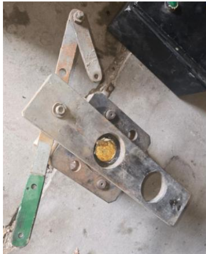
Figura 5-20: Sistema cambiador de filtros original manual.
