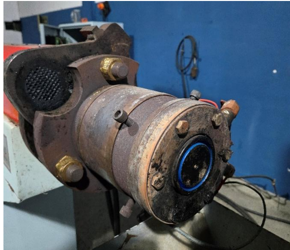
Figura 6-4: Cabezal y cambiador manual de filtros. Plásticos del mar.
