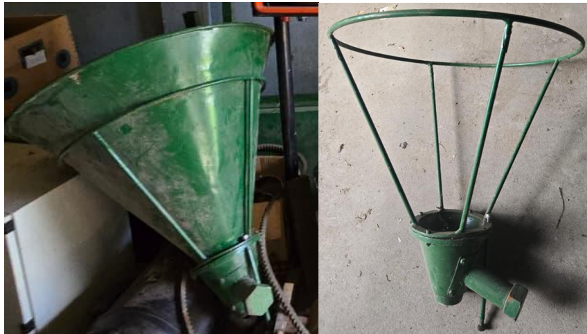
Figura 5-5: Detalle Tolva original.
