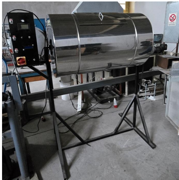
Figura 7-3: Horno de secado de escamas de PET. INTEMA
