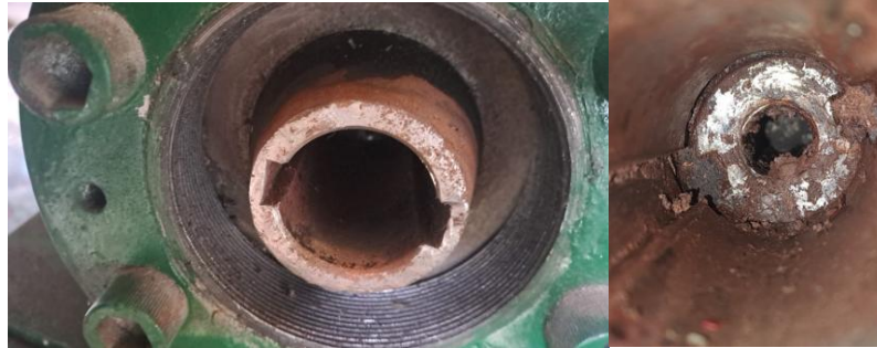
Figura 11-4: Corrosión en el acople del tornillo
