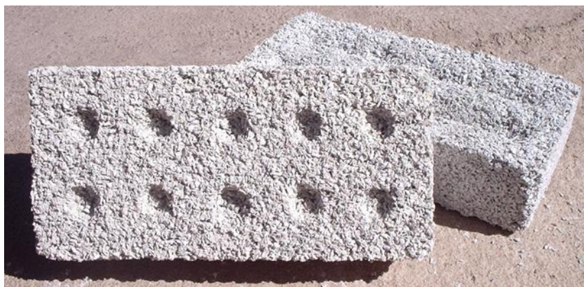
Figura 13-1: Ladrillo fabricado con adición de escamas de PET.
