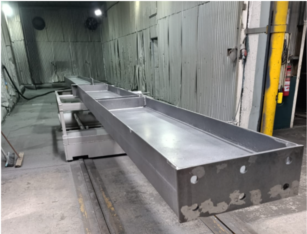
Figura N° 7: Viga en la cabina de granallado. Fuente: Imagen tomada en las visitas a la empresa.
