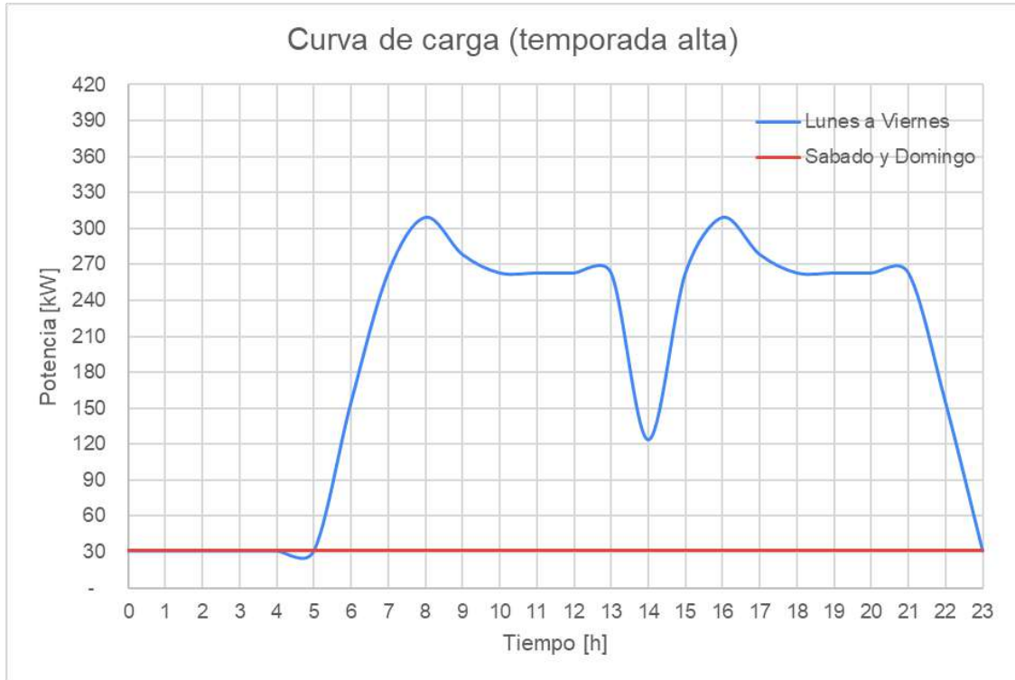
Figura 4.5.2. Curva de carga estimada durante la temporada alta. Fuente: elaboración propia.
