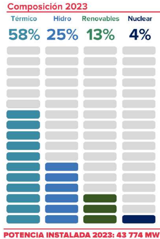
Figura 2.2.4. Matriz de generación eléctrica en Argentina obtenido del Informe Anual 2023. Fuente: CAMMESA [11]
