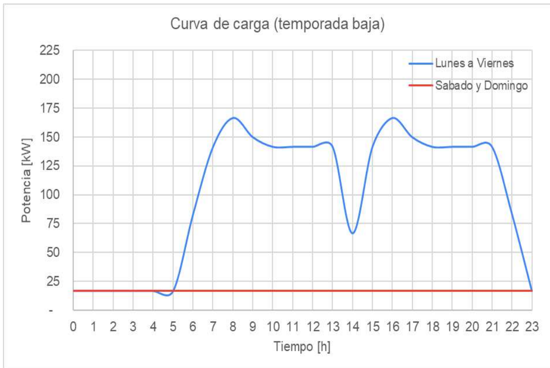
Figura 4.5.3. Curva de carga estimada durante la temporada baja. Fuente: elaboración propia.
