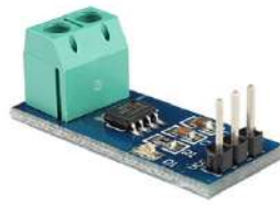
Ilustración 3: Sensor de Corriente Arduino ACS712
