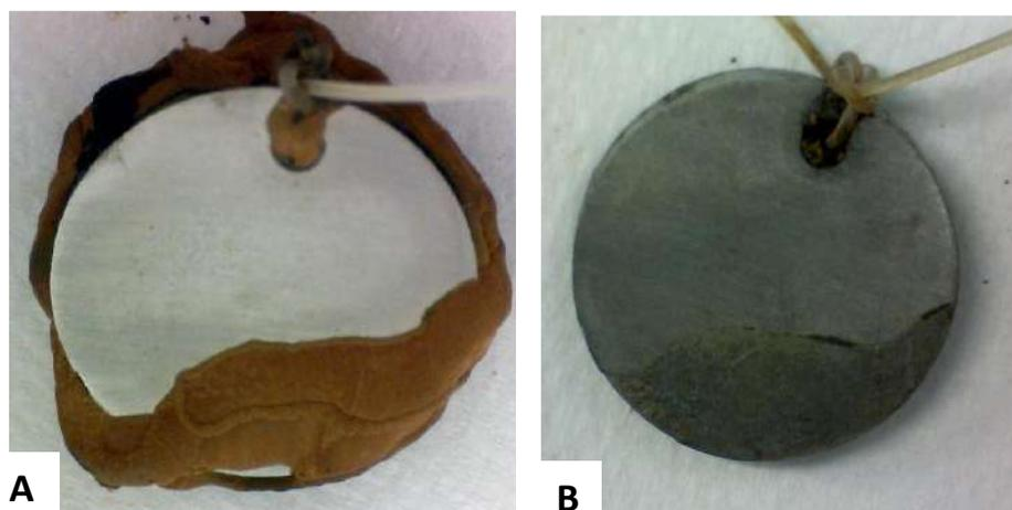
**Figura 61.** Fotografías de los cupones ensayados a 60 días de la condición P-Si1-60dSAA+Cl. Antes (A) y después (B) de la limpieza química.
