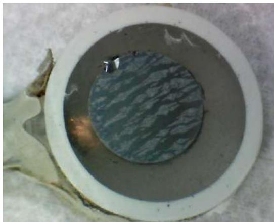
**Figura 24.** Macrografía sobre sustrato metálico para la condición SGpH11-15-1C.
