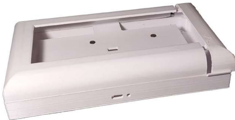
Figura 4.2: Carcasa impresa en 3D.
