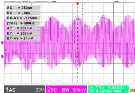
Figura F.16: Medición con actuador piezoeléctrico en osciloscopio.
