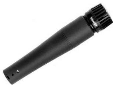
Figura F.4: Micrófono utilizado para la medición de emisión.
