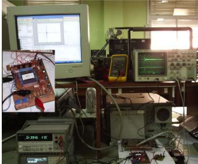
Fig. 4.31: Banco de pruebas usado, con detalle de la placa de mediciones con el CI incorporado.
