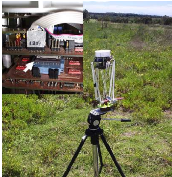
Fig. 5.15: La BSU en el campo, junto con un detalle de la unidad con el CI estimador de lazo cerrado incorporado.
