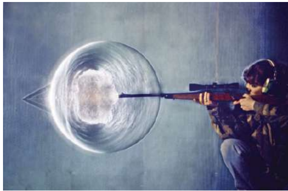
Fig. 2.1: Imagen Schlieren de alta velocidad de un rifle calibre .30-06 haciendo fuego. La bala sale a aproximadamente Mach 2.5. Son claramente perceptibles tanto la esfera acústica producto del estallido de boca, como el cono que va produciendo la onda de choque. Fotografía de Gary Settles [7].
