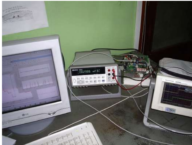
Fig. 5.24: Banco de pruebas usado para el estimador lineal. Las señales de estímulo provienen de la FPGA, que también recoge los resultados del CI y los envía por RS-232 a Matlab (ver Subsección 5.3.2 para más detalles). En la imagen, el circuito se encuentra midiendo un retardo de 355\mu\text{s} , equivalente a 71 cuentas en el estimador.
