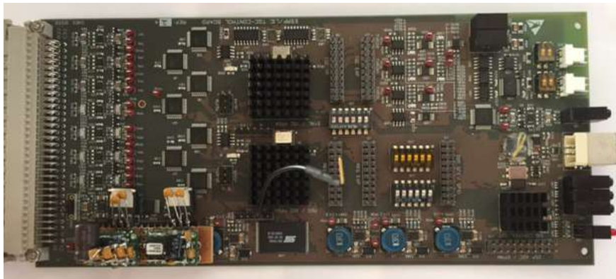
Figura 7.1: Placa del nuevo Sistema de disparo TGC con el control de lazos y circuitos de adquisición, en etapa de desarrollo.
