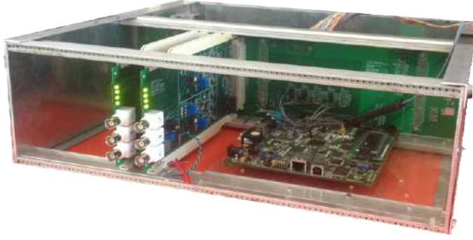
(a) Placas de acondicionamiento, detección de cruces y control.
