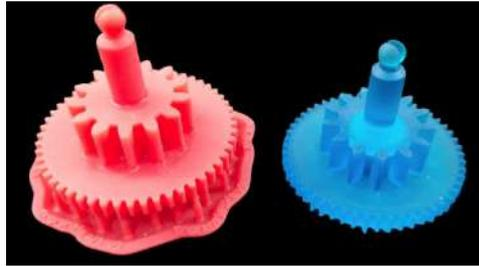
*Figura 14. Piezas obtenidas por impresión 3D SLA.*
