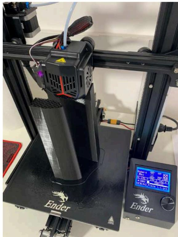
*Figura 53. Impresión de una de las partes del ala total que se utilizará como molde.*
