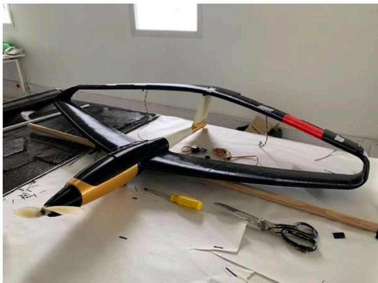
*Figura 27. Procedimiento de localización y ajuste del CG.*
