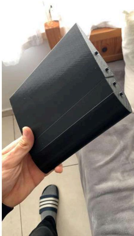
*Figura 54. Parte del ala total con sistema de encastre.*
