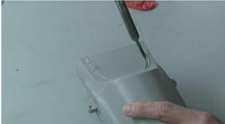
*Figura 21. Material removido mediante el uso de soldador eléctrico.*
