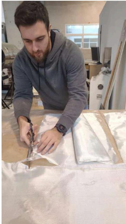
*Figura 68. Corte tela de fibra y cobertura de pieza.*
