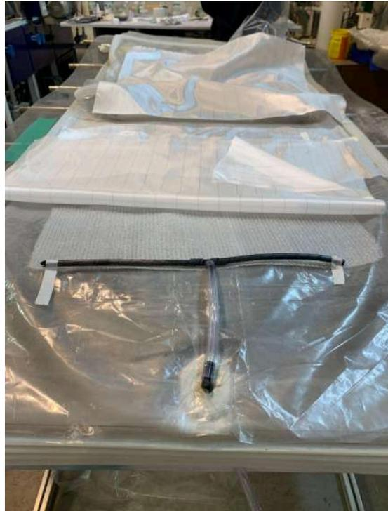
*Figura 69. Malla de flujo y peel ply.*
