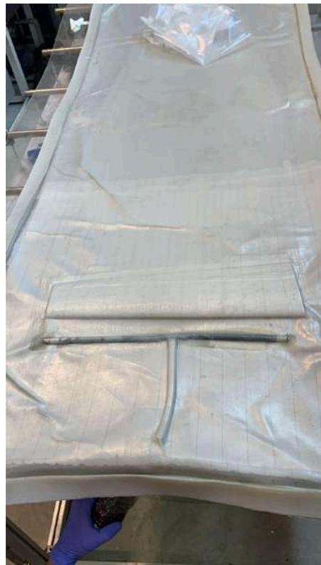
*Figura 70. Colocación de resina en manguera para comienzo de proceso de "infusión por vacío".*
