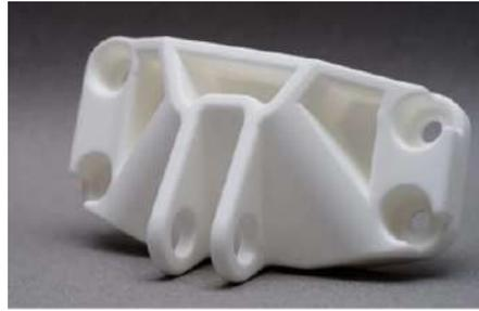
*Figura 16. Pieza fabricada por impresión 3D SLS.*
