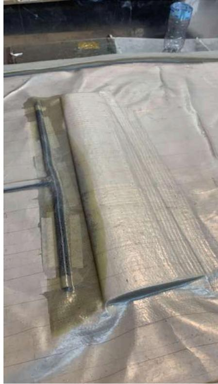
*Figura 71. Instante en el que la resina comienza a recubrir la pieza a procesar.*
