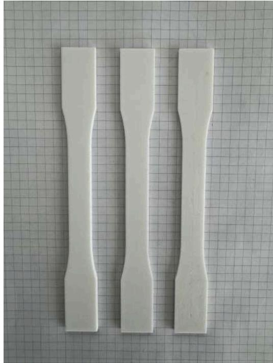
*Figura 33. Algunas probetas a ensayar.*
