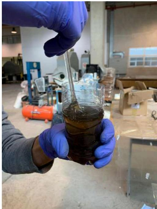
*Figura 59. Mezcla de resina y catalizador.*
