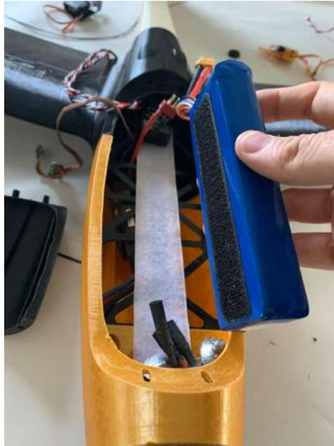
*Figura 25. Colocación de componentes electrónicos.*
