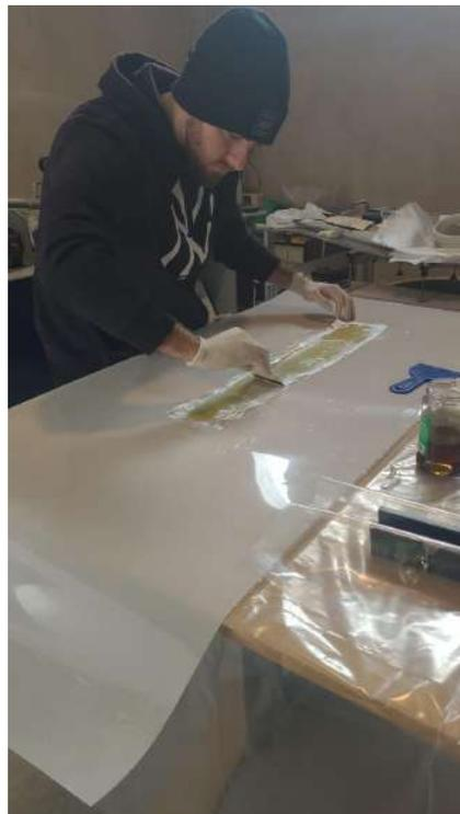
*Figura 60. Proceso de laminado de fibra de vidrio.*
