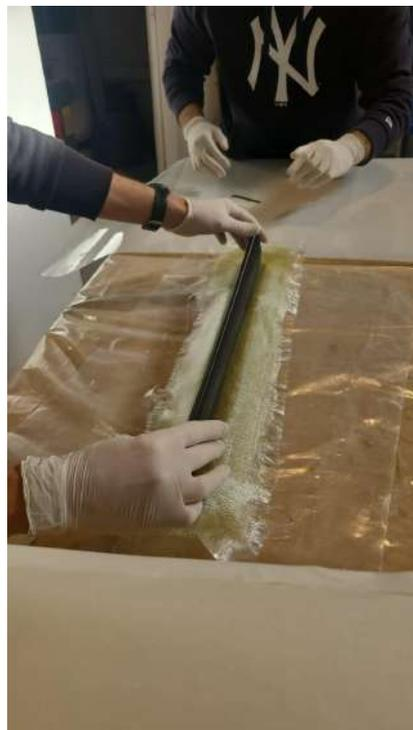
*Figura 62. Colocación del núcleo dentro del molde con los recortes de fibra.*
