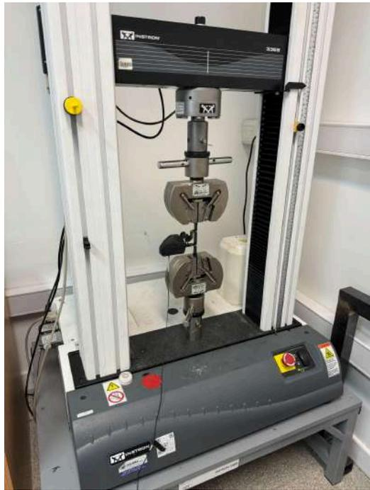
Figura 28. Máquina universal de ensayos Instron 3369.
