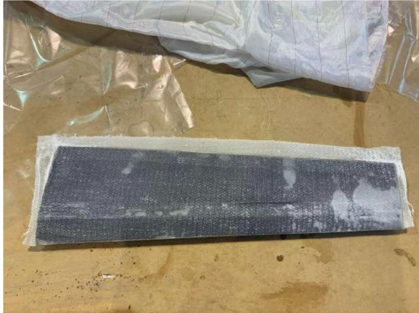
*Figura 72. Pieza de sacrificio de PLA, envuelta en compuesto.*
