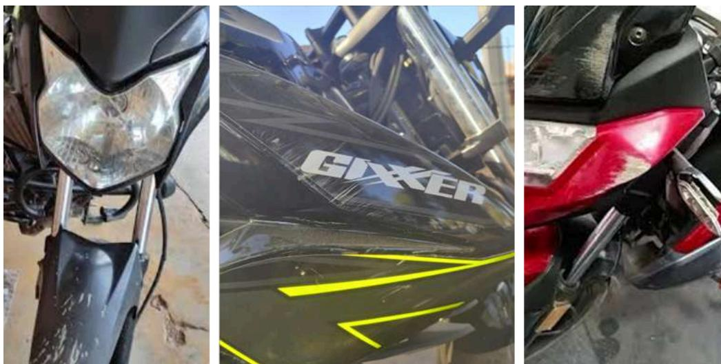
Figura 1-3. Ejemplos de daños por rayado en motos.
