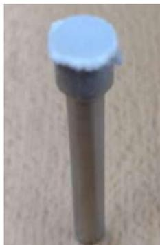
Figura 3-9. Pin utilizado en el ensayo de pin on disk.
