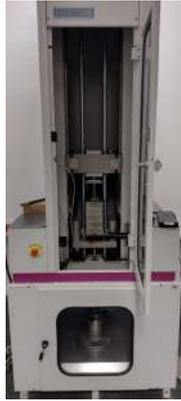
Figura 4-18. Máquina para ensayo de impacto instrumentado Ceast Fractovis Ceast Falling Weight.
