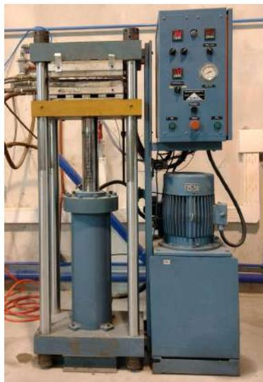
*Figura 2-1. Prensa utilizada para moldeo por compresión.*
