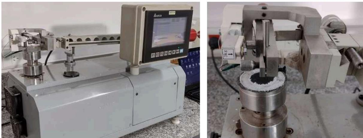
Figura 3-7. Tribómetro *pin on disk*: (a) vista general, (b) detalle del disco abrasivo y del brazo portamuestra.
