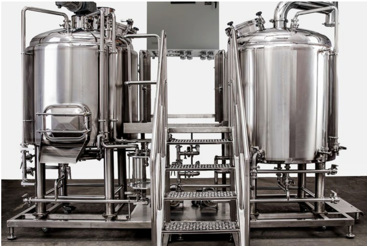
Figura 2: Olla de cocción, maceración y barrido.
