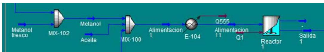
Figura 3.2: Reactor de transesterificación y corrientes asociadas, simulado en Unisim Design.
