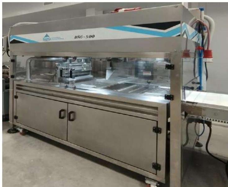
Figura 25: Máquina bañadora de la línea de alfajores.
