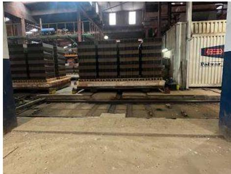
Figura 40: Desnivel en acceso a horno.
