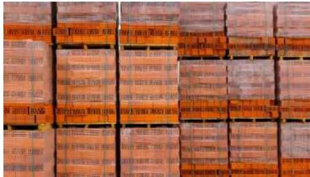
Figura 48: Elásticos ajustados al pallet de ladrillos.
