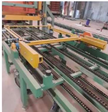
Figura 62: Rotador de pallets.
