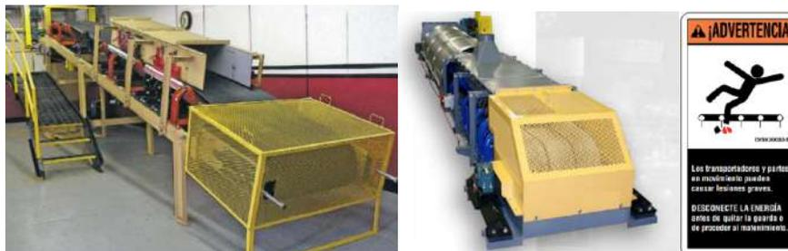
Figura 49: Guardas de seguridad en cintas transportadoras / Cartelería para atrapamiento por mecanismo móvil.
