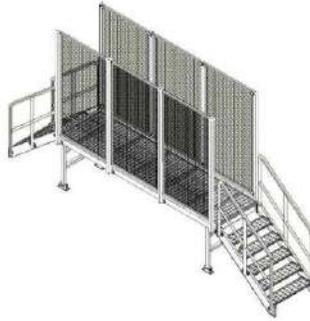
Figura 45: Estructura de escalera puente reforzada.
