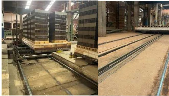
Figura 36: Sistema de transporte de carga (vagonetas y rieles).
