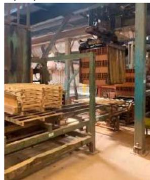
Figura 34: Pinza desapiladora de ladrillos.
