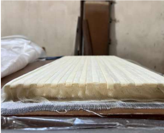
Figura 4.7. Panel post curado asistido por vacío
