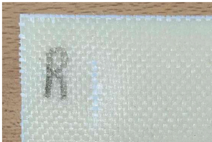
Figura 5.12. Falla de la piel de una probeta STR
