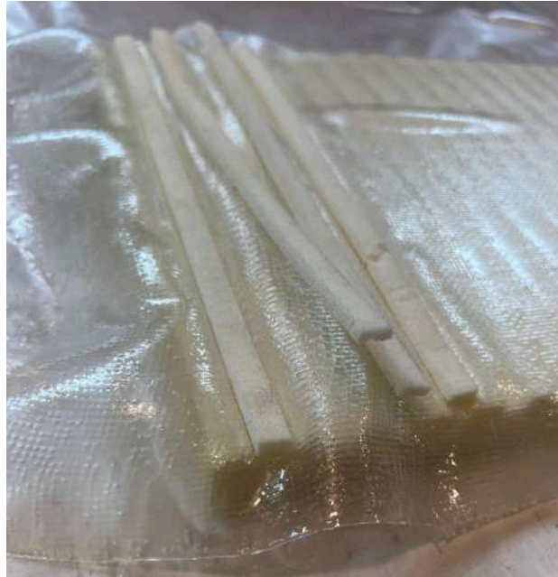
Figura 8.1. Prueba de fabricación de panel corrugado con tela de 6 oz
