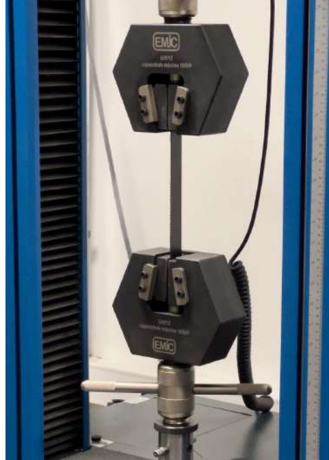
Figura 4.9. Configuración del ensayo de tracción uniaxial
