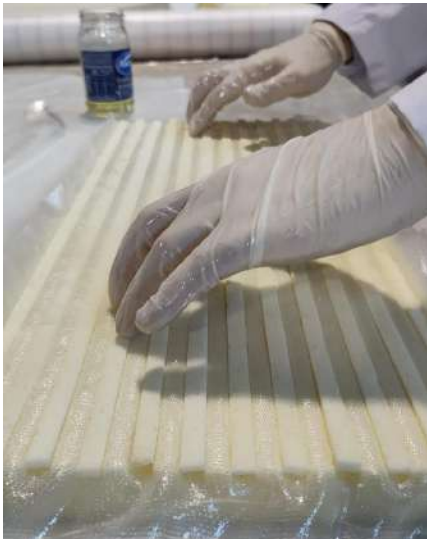
Figura 4.5. Colocación de las vigas de PU
