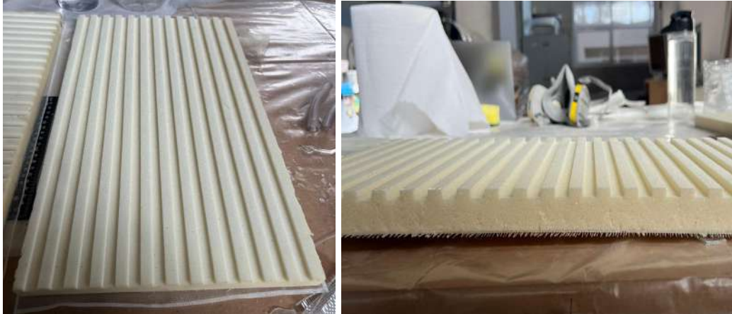
Figura 4.4. Paneles con corrugado longitudinal y transversal.
