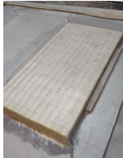
Figura 4.6. Curado asistido por vacío
