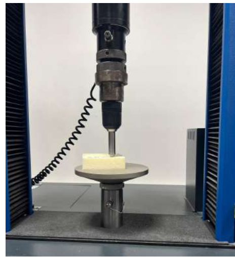
Figura 4.12. Ensayo de indentación cuasi-estática
