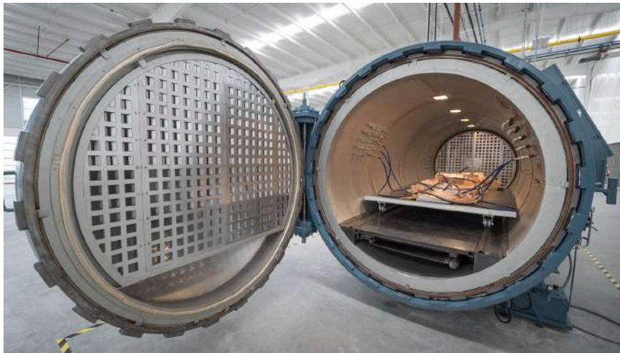
Fig 2.3: Ducto inferior en un Econoclave ASC [12]
