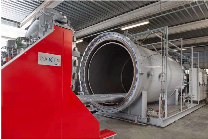
Fig 2.2: Cámara interna anular en un autoclave Daxen [11]
