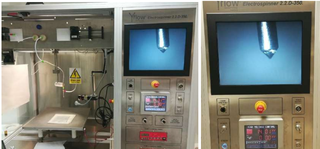
Figura 10. Imagen del cono de Taylor obtenida en la práctica experimental.
