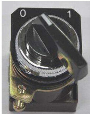
Figura 20: Selector a palanca (8100 N) utilizado para la reforma de la extrusora
