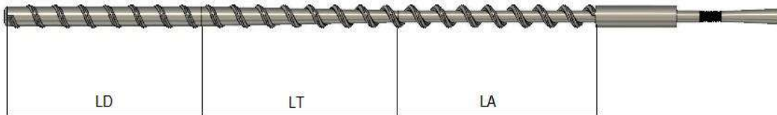
Figura 11: Representación del tornillo de la extrusora a utilizar. Longitudes de alimentación, transición y dosificación (LA, LT, LD).
