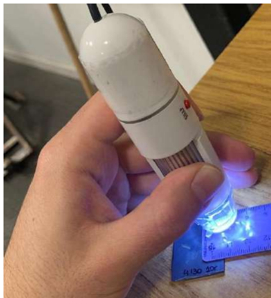
Figura 51: Medición experimental de entallas
