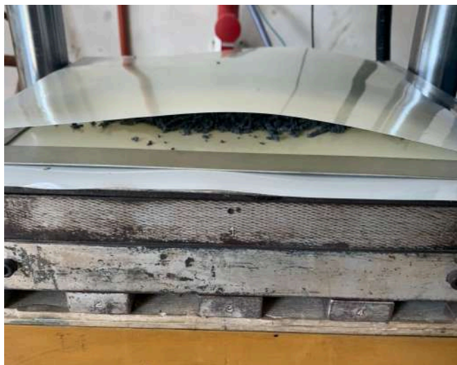
Figura 37: Colocación del material en la prensa (previo a la aplicación de presión)
