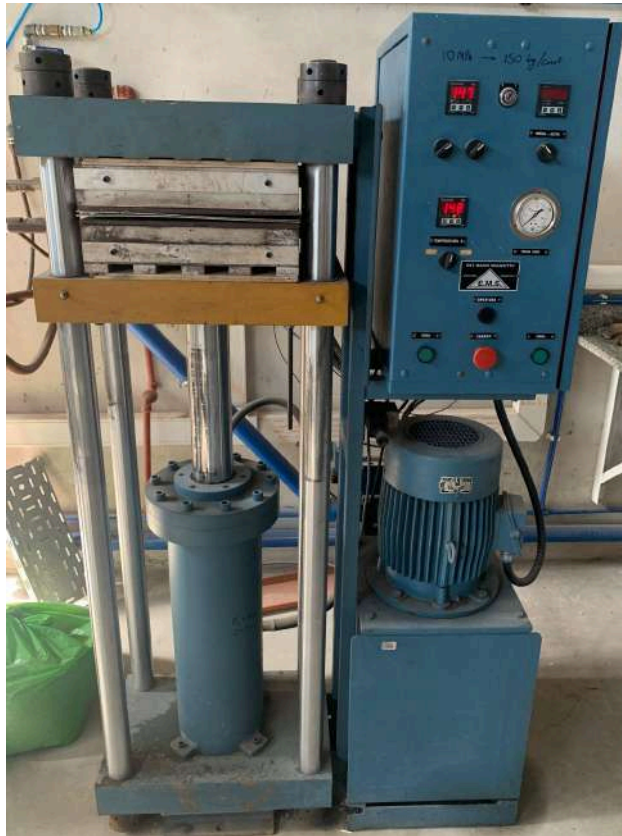
Figura 34: Prensa utilizada para moldeo por compresión
