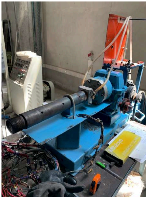
Figura 7: Extrusora Moroz desarmada - Previo al reacondicionamiento
