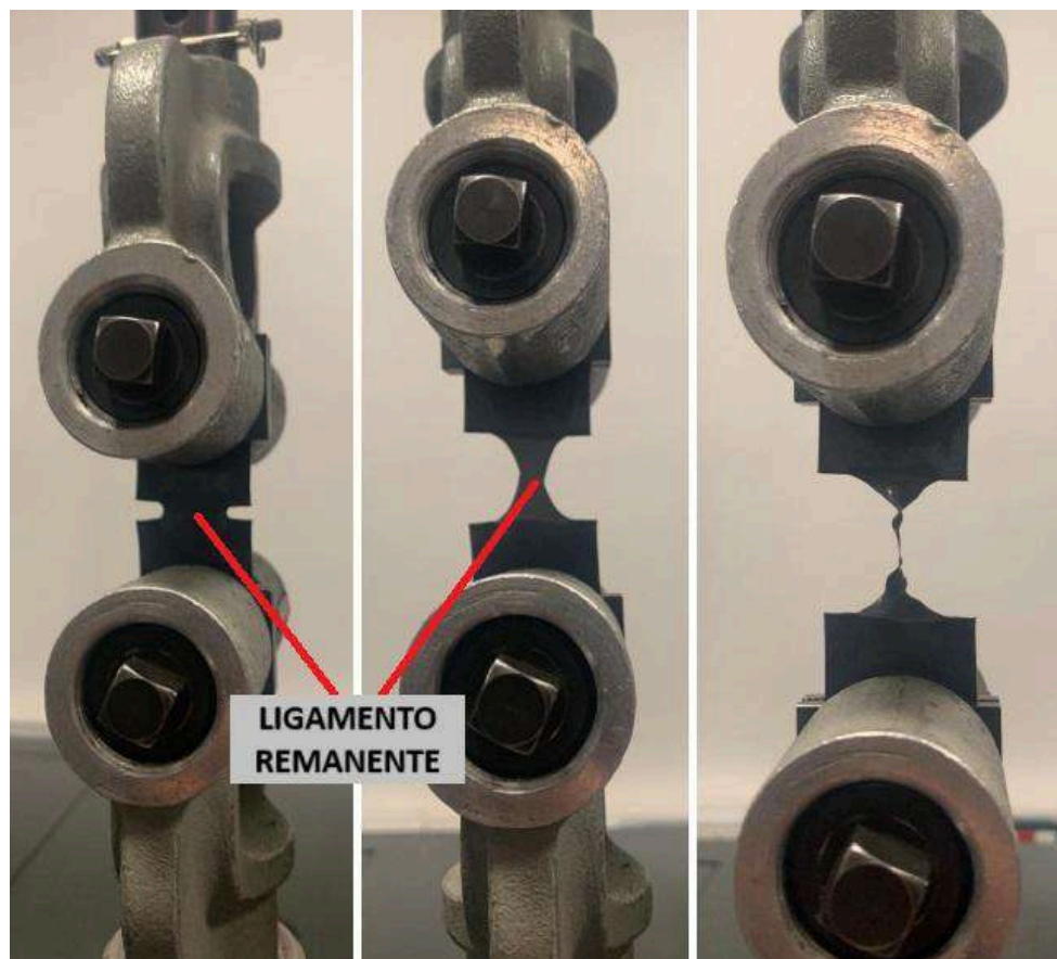
Figura 52: Ensayo bajo el modo I de fractura. Deformación inicial (izquierda), acuellamiento (centro), rotura o falla (derecha)
