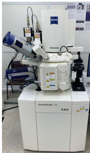
Figura 29: Microscopio electrónico de barrido - Zeiss Gemini Crossbeam 350
