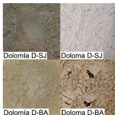
Figura II.3.1. Polvos de dolomía original (izquierda) y luego del tratamiento térmico de calcinación a 950 °C (derecha).
