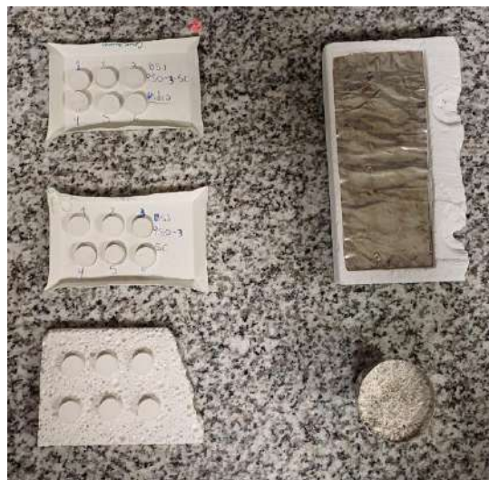
Figura III.2.3. Material preparado (discos y polvo) para el sinterizado.
