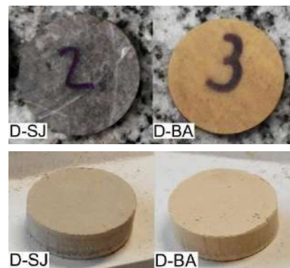
Figura II.2.3. Discos de las rocas naturales (arriba) y prensados (abajo).
