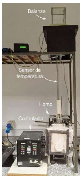
Figura II.2.1. Horno eléctrico de cámara usado en los tratamientos térmicos.
