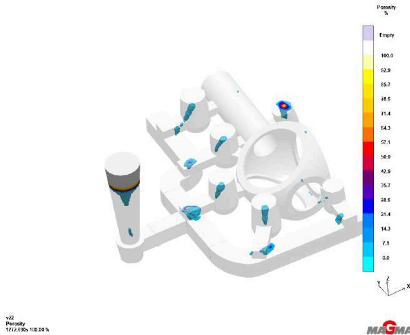
Figura 71. Porosidad de la pieza Hub-Eje lento con una temperatura de colado de 750 °C. Sistema de alimentación SH3 sin uso de chills.
