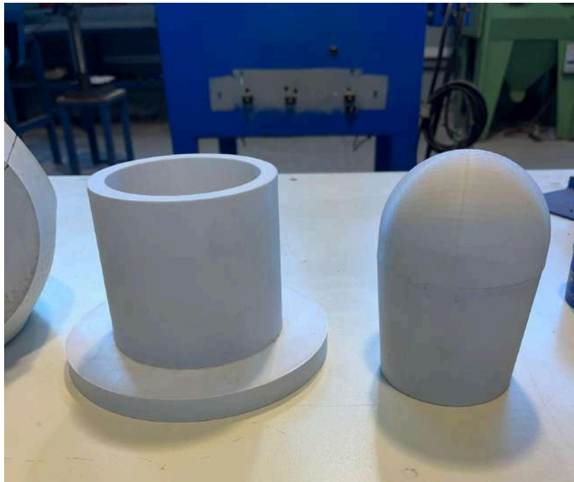
Figura 44. Modelo de buje con brida junto a una mazarota
