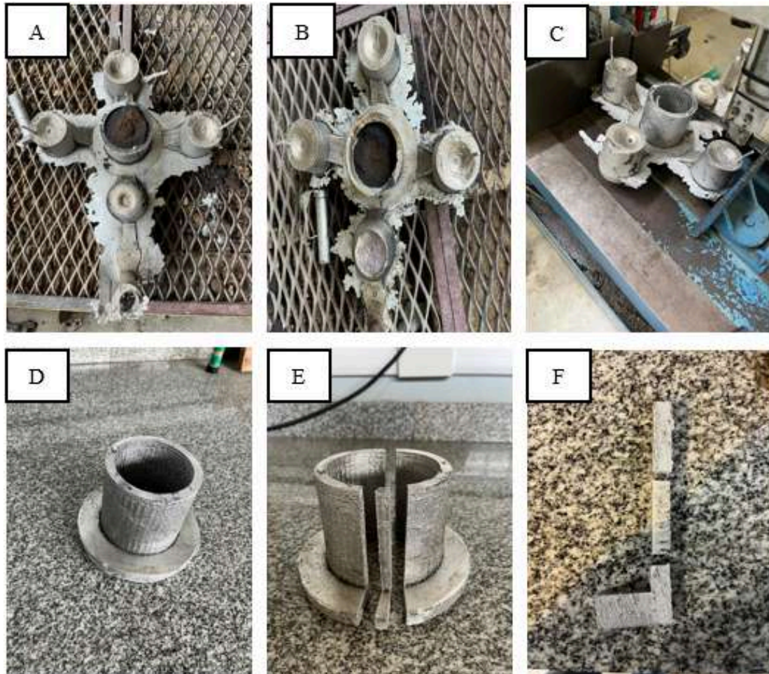
Figura 46. Coladas de Bidas con caño: a) AlSi10Mg, b) AlSi7Mg, c) Seccionamiento de sistema de alimentación, d) Brida con caño, e) Seccionamiento para obtener probeta para estudio de porosidad, f) Sección transversal de la brida, cortada en tres partes para facilitar observación de porosidad
