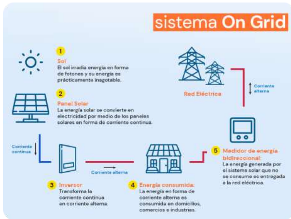
Figura 7. Componentes de un sistema On Grid.
