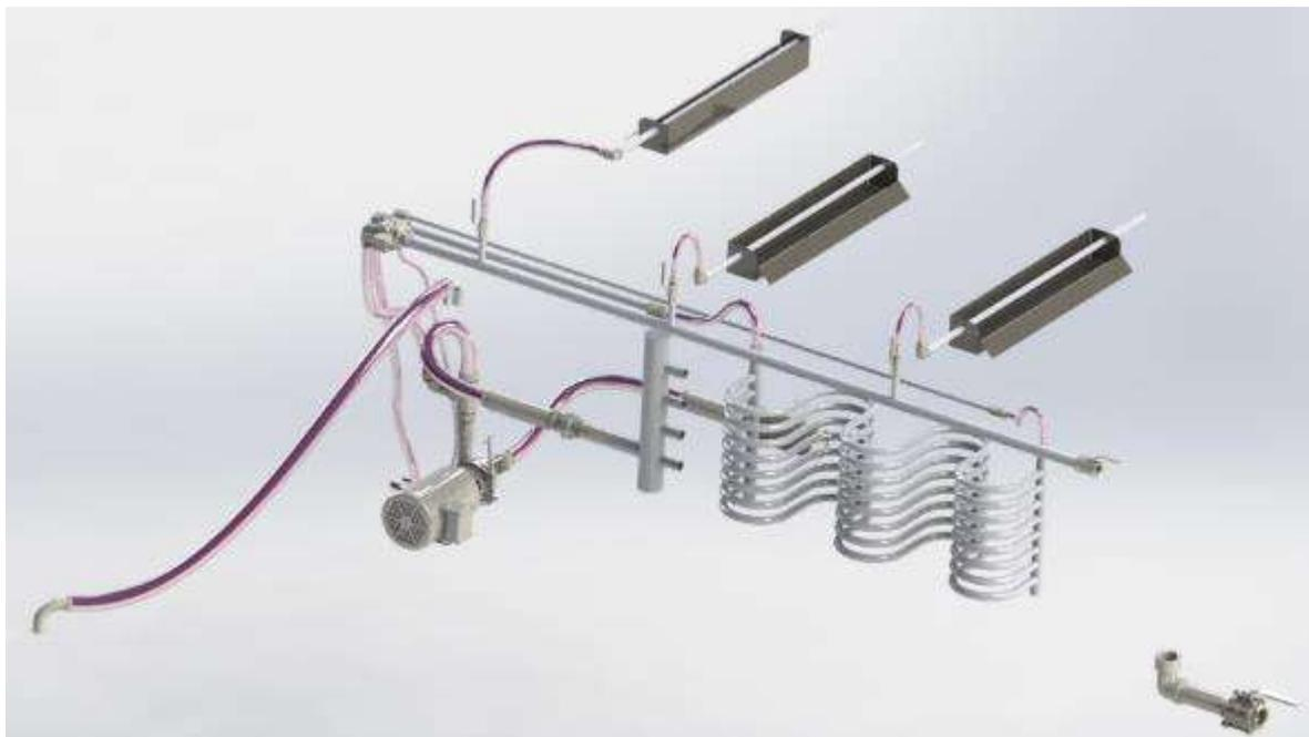
Figura 20. Modelo del piping de la glaseadora.
