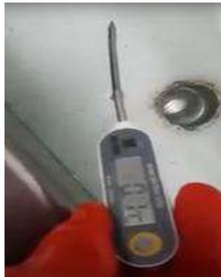
*Figura 29* Medición de la temperatura del agua mediante termómetro digital
