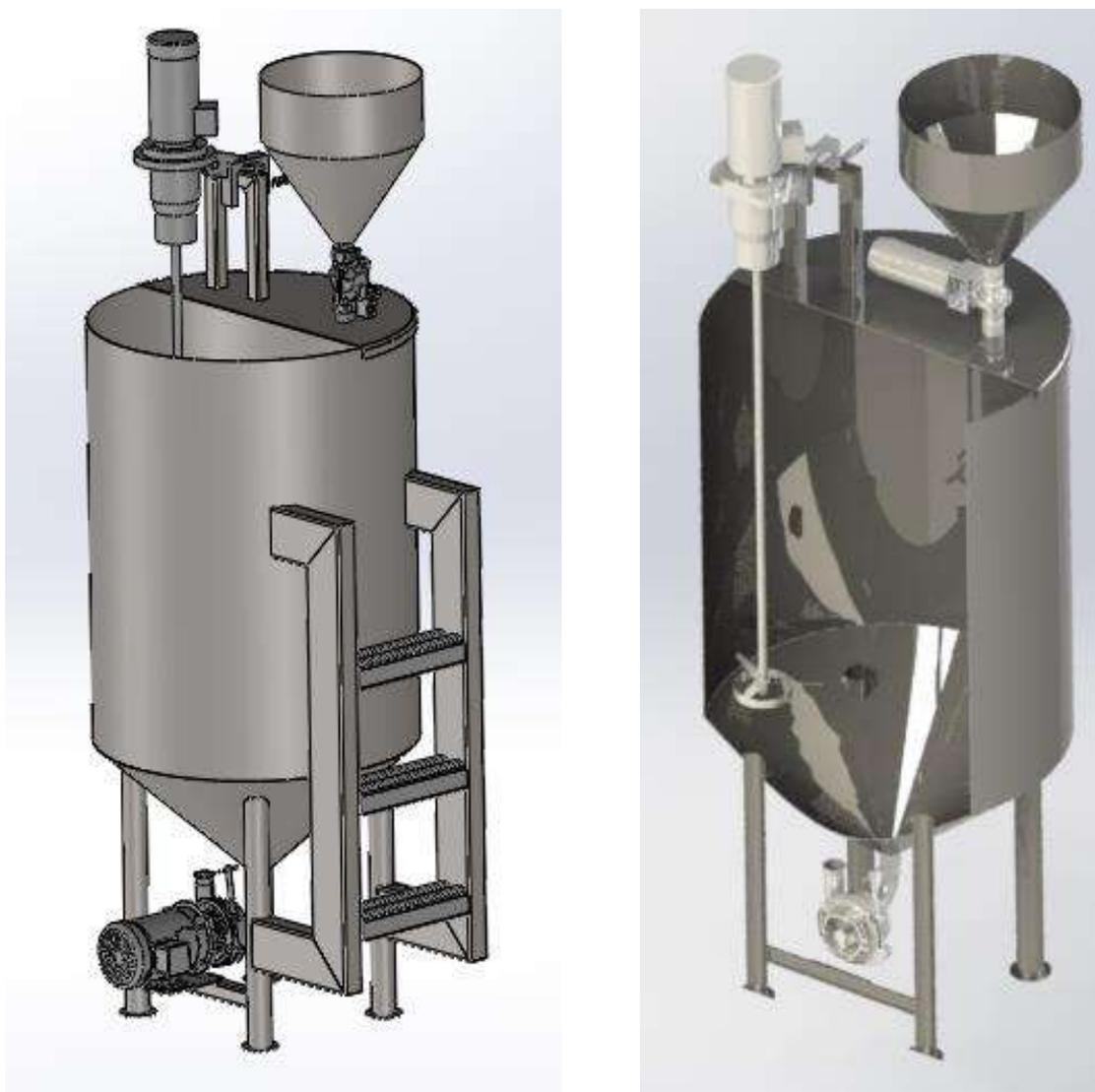
*Figura 28. Preparador y dosificador de salmuero. Modelo completo y vista en corte.*
