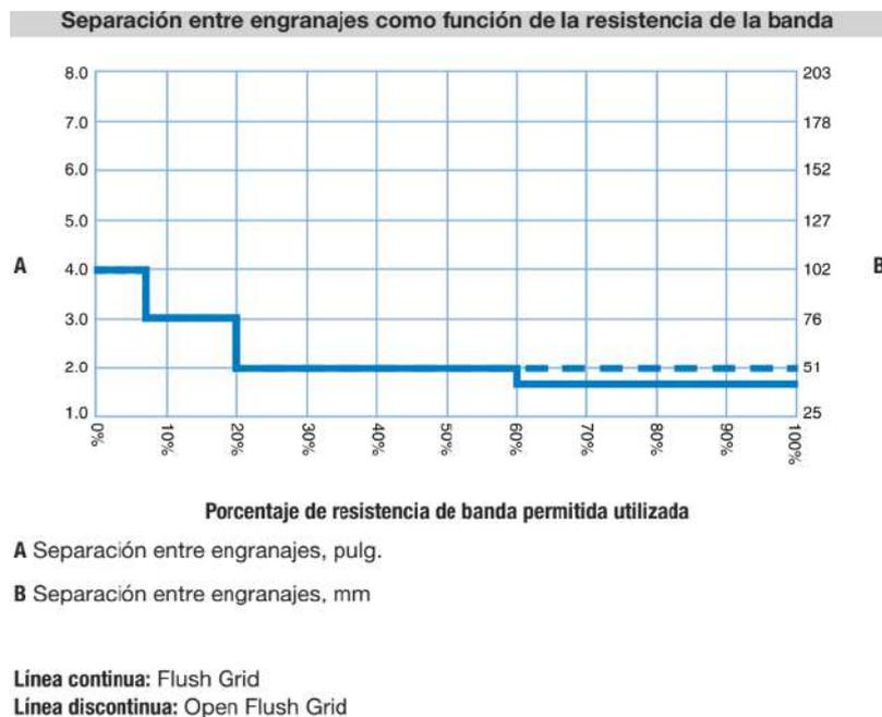
Figura 37. Separación entre engranajes como función de la resistencia de la banda.
