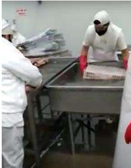
*Figura 2 Operario sumergiendo la pastilla en la batea refrigerada.*
