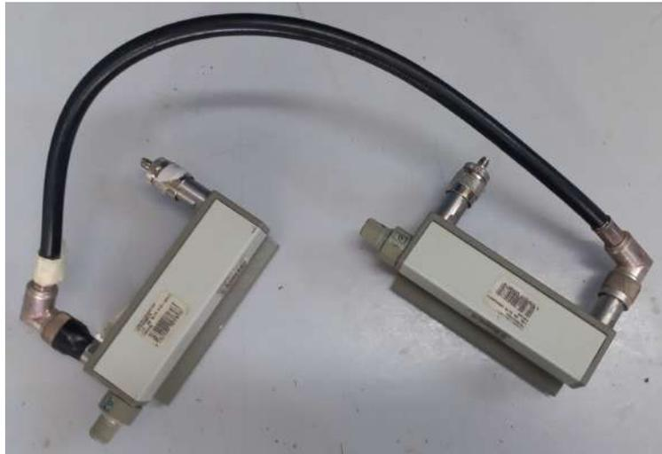
Figura C.24: Atenuadores utilizados para la calibración.
