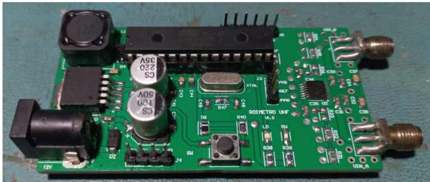
Figura C.13: Placa microcontrolador-detector ensamblada.
