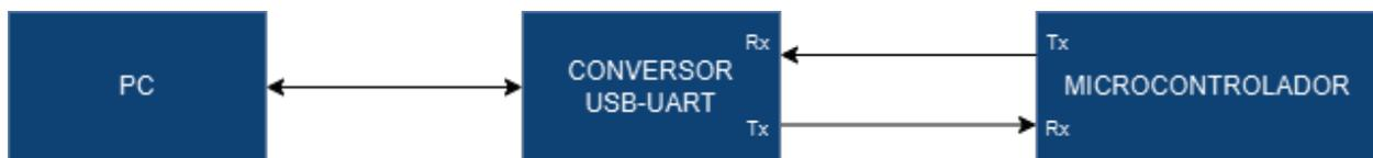
Figura C.3: Conexión del módulo de comunicación.
