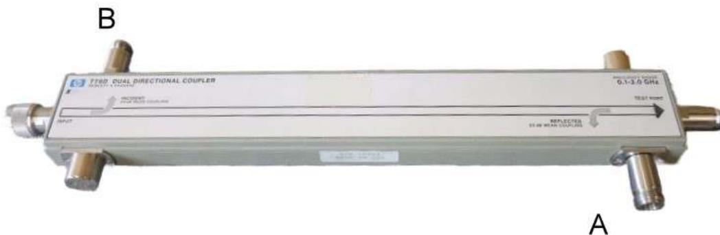
Figura C.15: Acoplador bidireccional HP778D utilizado para el roímetro.
