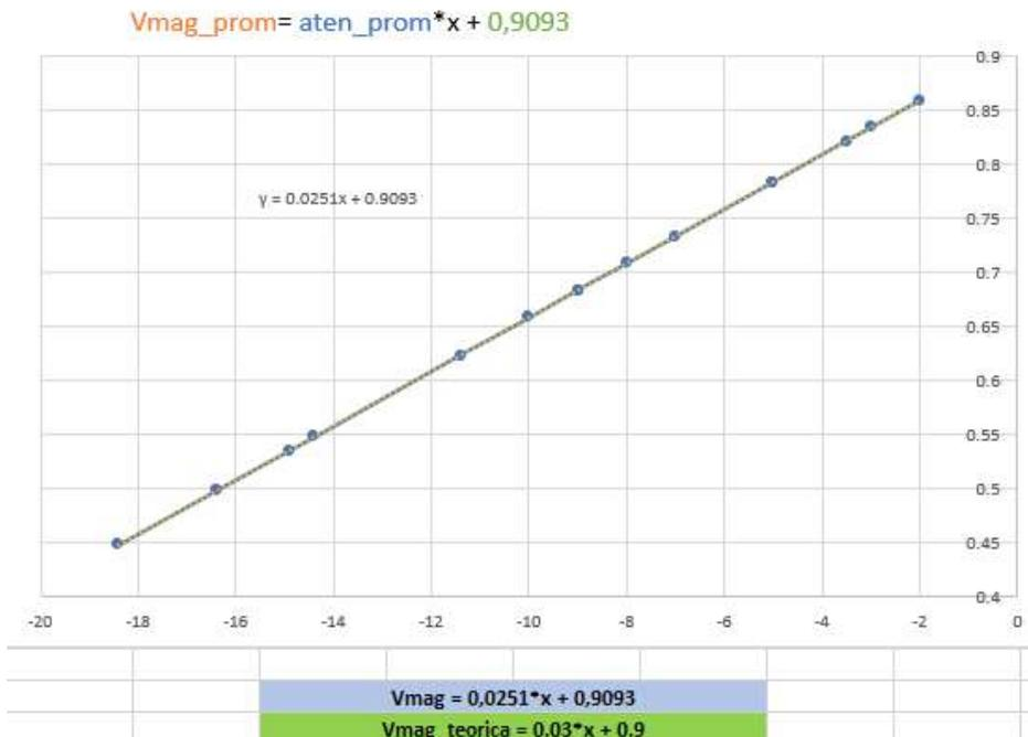
Figura D.5: Curvas real del detector (Vmag promedio vs atenuación promedio).
