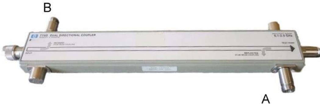
Figura 3.10: Acoplador bidireccional HP778D utilizado para el roímetro.
