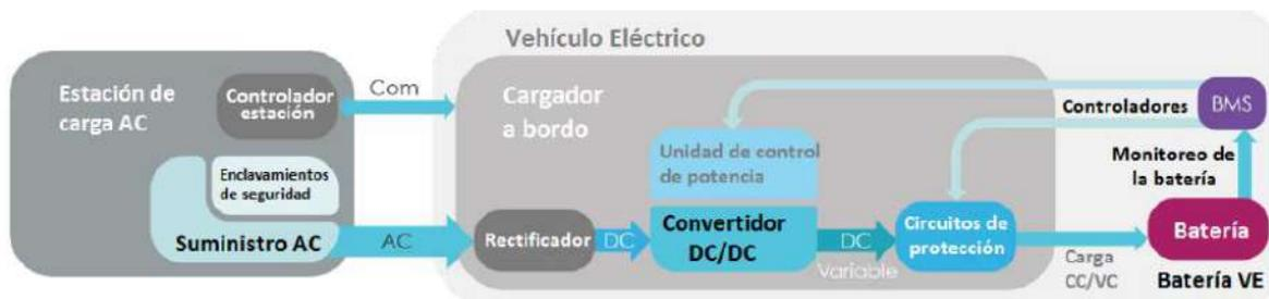
Figura 13 - "Esquema funcionamiento carga AC." [5]
